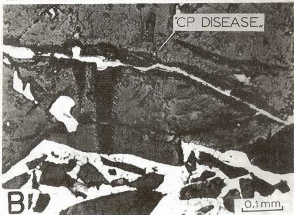
Εικ. 1. Χαλκοσιφίτης (cp) κατά μήκος μικροδιακλάσεων του σφαλερίτη (sp) (Α) ανακλάμενο φως, και (Β) διερχόμενο φως. Μεταλλείο Ολυμπιάδα, Α. Χαλκιδική.
