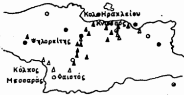
Σχ.5. Χάρτης με επίκεντρα σεισμών Κρήτης, των οποίων η πρώτη κίνηση αναγράφηκε στο Σεισμολογικό σταθμό Αθήνας ως κύμα πύκνωσης (+) ή ως κύμα αραίωσης (-) από Κισκύρα (1957). Fig.5. Map of Crete (Kiskyras 1957) with epicenters of some shocks the first motion of which has been recorded in Athens as compression (+) or as dilatation wave (-).
