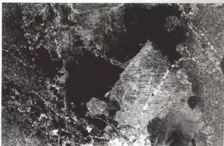
Εικ. 3. Αδροκρύσταλλοι δολομίτη saddle. Σημειώστε τις επαλω- τές κρυσταλλικές επαφές και την έντονη κυματοειδή κατάσβεση των κρυσ- τάλλων. ⊥ Nicols, 30X
