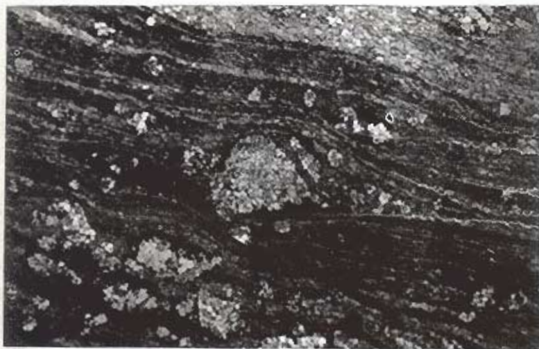
Εικ. 4. Μικροκόνδυλοι δολομίτη saddle, σε λεπτοστρωσιγενές μικροκρυσταλλικό ασβεστολιθικό πέτρωμα. Οι λεπτοστρώσεις ακολουθούν την περιφέρεια των μικροκονδύλων αποσφηνούμενες εκατέρωθεν αυτών. // Nicols, 30X
