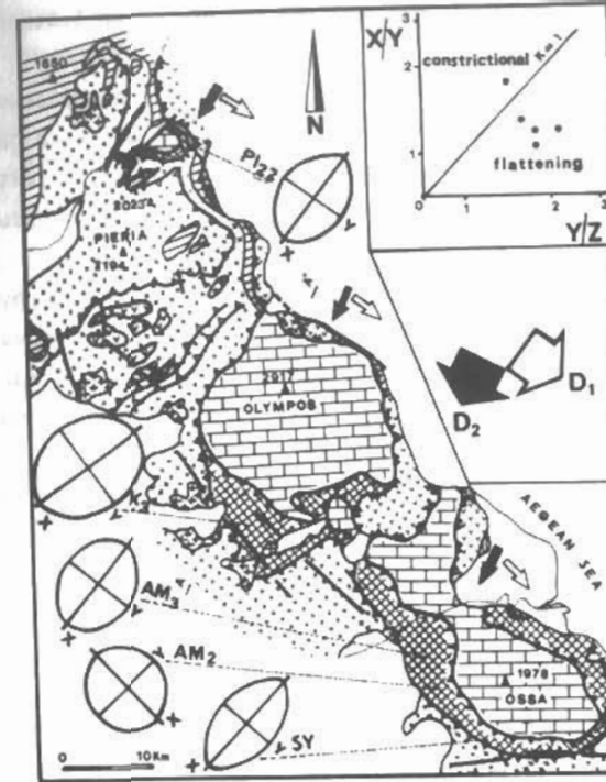
Σχ. 5. Τελικά ελλειψοειδή παραμόρφωσης σε XY-τομές και απεικόνιση τους στο διάγραμμα Flinn ( Z=1 ). Τα βέλη δείχνουν την έννοια της κίνησης, κατά τα δύο κύρια D_1 - και D_2 -παραμορφωτικά γεγονότα. (Συμβολισμοί βλέπε σχ. 1, το κρυσταλλοσχιστώδες υπόβαθρο του Πελαγονικού καλύμματος λαμβάνεται εδώ αδιαίρετο).
