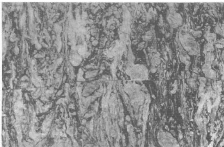
Εικ. 4: Ίχνη της σχιστότητας S_1 σε δομές μικροπτυχών, που διατηρούνται παρά την έντονη μυλωνιτίωση και την νεώτερη μικροδιάρρηξη. Δείγμα 22, τομή παράλληλη προς την γράμμιση, παράλληλη Nicols, X32.
