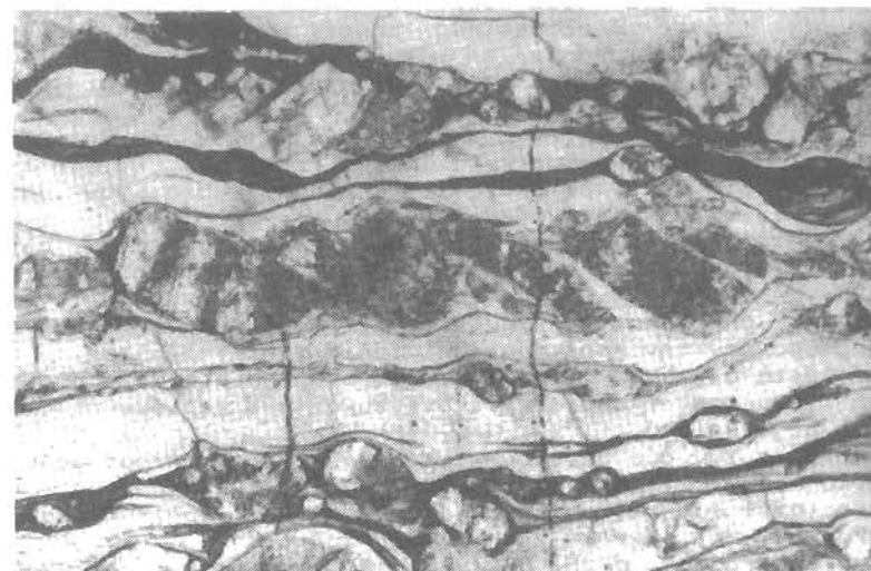
Εικ. 9: Πορφυροκλάστης πλαγιόκλαστου που έχει υποστεί θραυσιγενή παραμόρφωση με περιστροφή των θραυσμάτων κατά την αριστερόστροφη φορά της διάτμησης (προς Βορρά). Ανατολικό τμήμα του γρανίτη Δ. Ικαρίας. Δείγμα 20, τομή παράλληλη προς τη γράμμωση, παράλληλα Nicols, X32.
