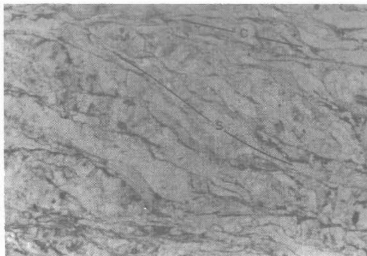
Εικ. 2: s-c μυλονιτικός ιστός στο δυτικό τμήμα του γρανίτη Δ. Ικαρίας με φορά διάτμησης προς Βορρά (αριστερά στη φωτογραφία). Δείγμα 27, παράλληλα Nicols, X12, τομή παράλληλη προς τη γράμμωση.
