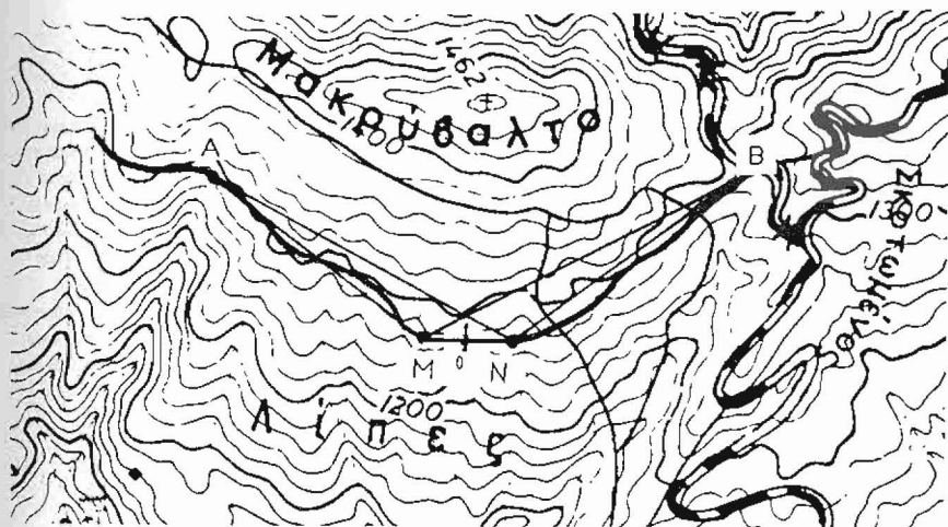
Σχ.3. Σχηματική απεικόνιση γενικής ηλεκτροδιακής διάταξης (A,M,N,B). O = Σημείο γεωηλεκτρικής βυθοσκοπήσεως. M,N = Σημεία ηλεκτροδίων δυναμικού. A,B = Σημεία ηλεκτροδίων ρεύματος.
