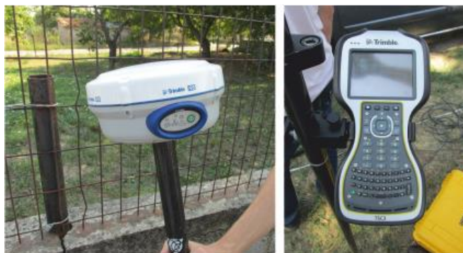
Εικόνα 3-5: Εξοπλισμός GPS Trimble R6 με χειριστήριο TSC3.
