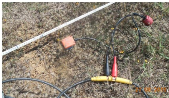
Εικόνα 3-22: Αριστερά: Καταγραφικό Strataview (Geometrics). Δεξιά: Γεώφωνα και συνδεσμολογία.
