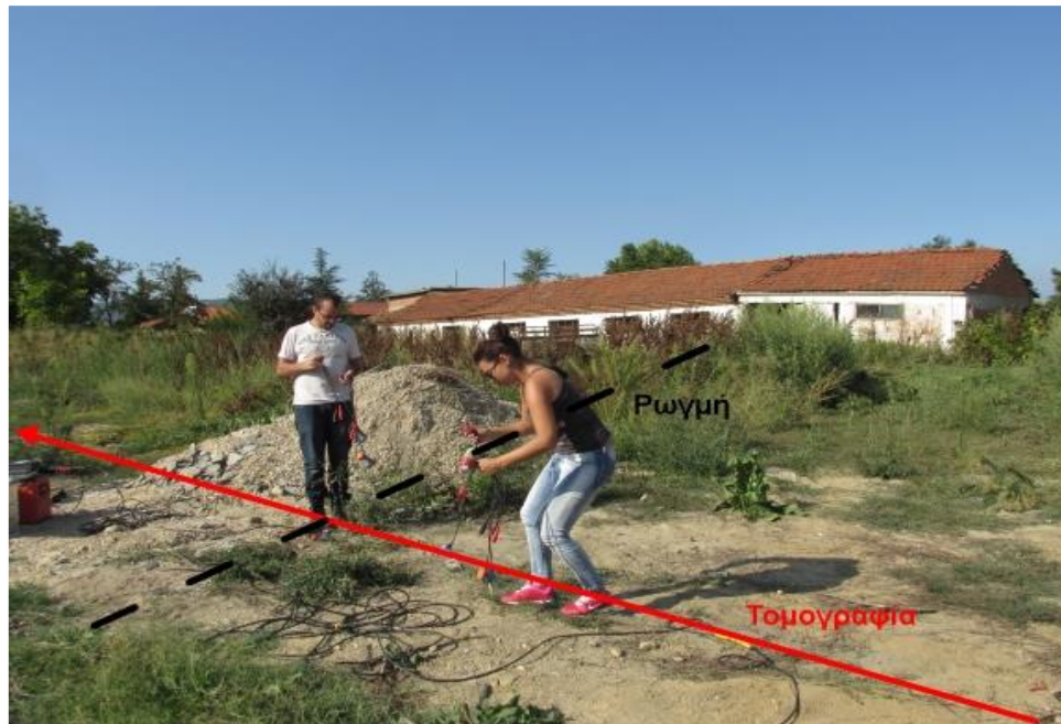
Εικόνα 3-10: Φωτογραφία στο σημείο των μετρήσεων, στην οποία απεικονίζονται το σημείο και η φορά της ηλεκτρικής τομογραφίας καθώς και το σημείο εμφάνισης της ρωγμής.
