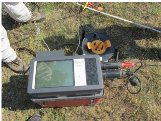
Εικόνα 3-22: Αριστερά: Καταγραφικό Strataview (Geometrics). Δεξιά: Γεώφωνα και συνδεσμολογία.
