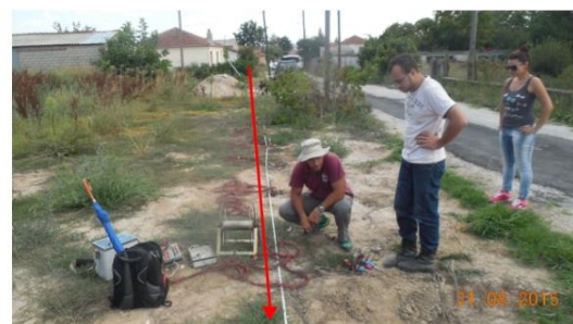
Εικόνα 3-3: Φωτογραφίες από τη λήψη μετρήσεων ηλεκτρικής τομογραφίας στις οποίες φαίνεται κ η φορά των μετρήσεων.
