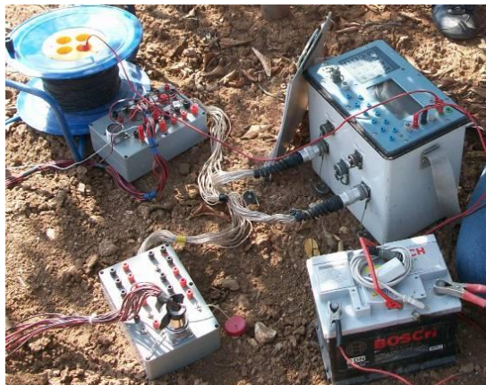
Εικόνα 3-4: Όργανο μέτρησης ηλεκτρικών μεθόδων Syscal καθώς και ο πρόσθετος εξοπλισμός που χρησιμοποιήθηκε.
