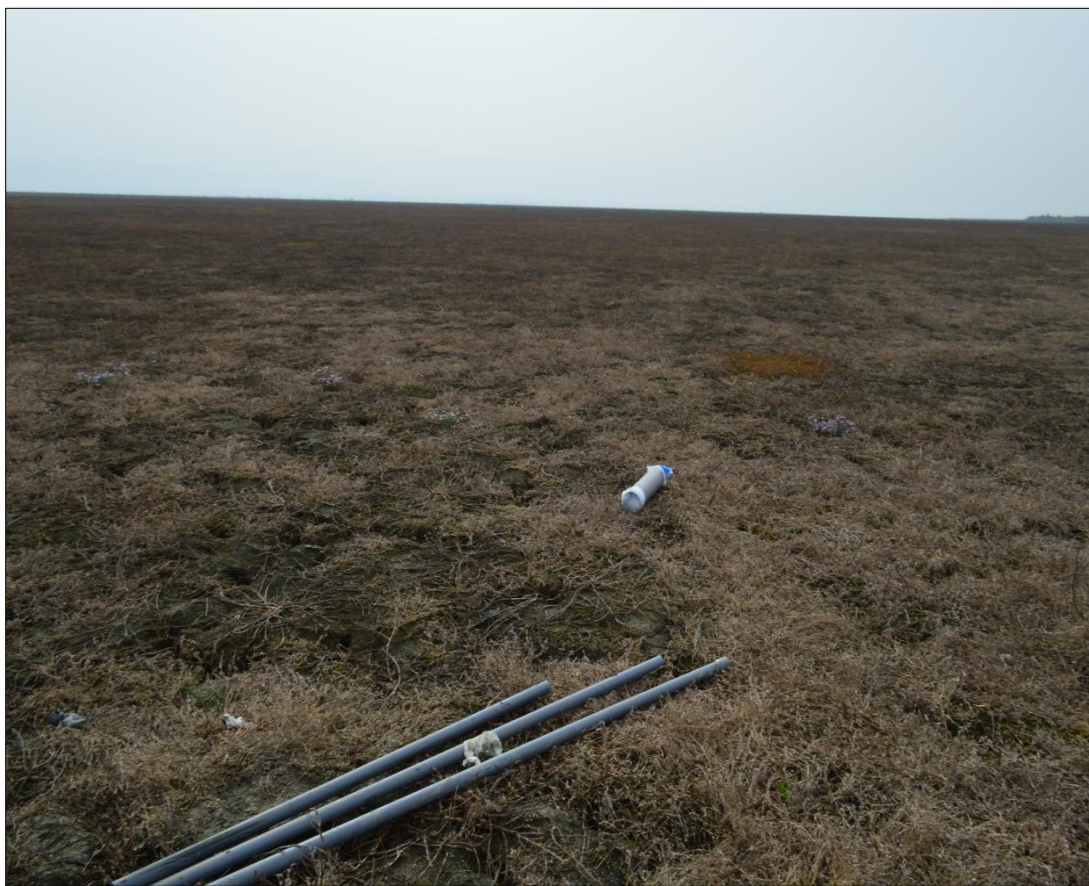
Σχήμα 15. PVC σωλήνες-οδηγοί, εξωτερικής διαμέτρου 40mm, με διαφορά μήκους 0.5m. .
