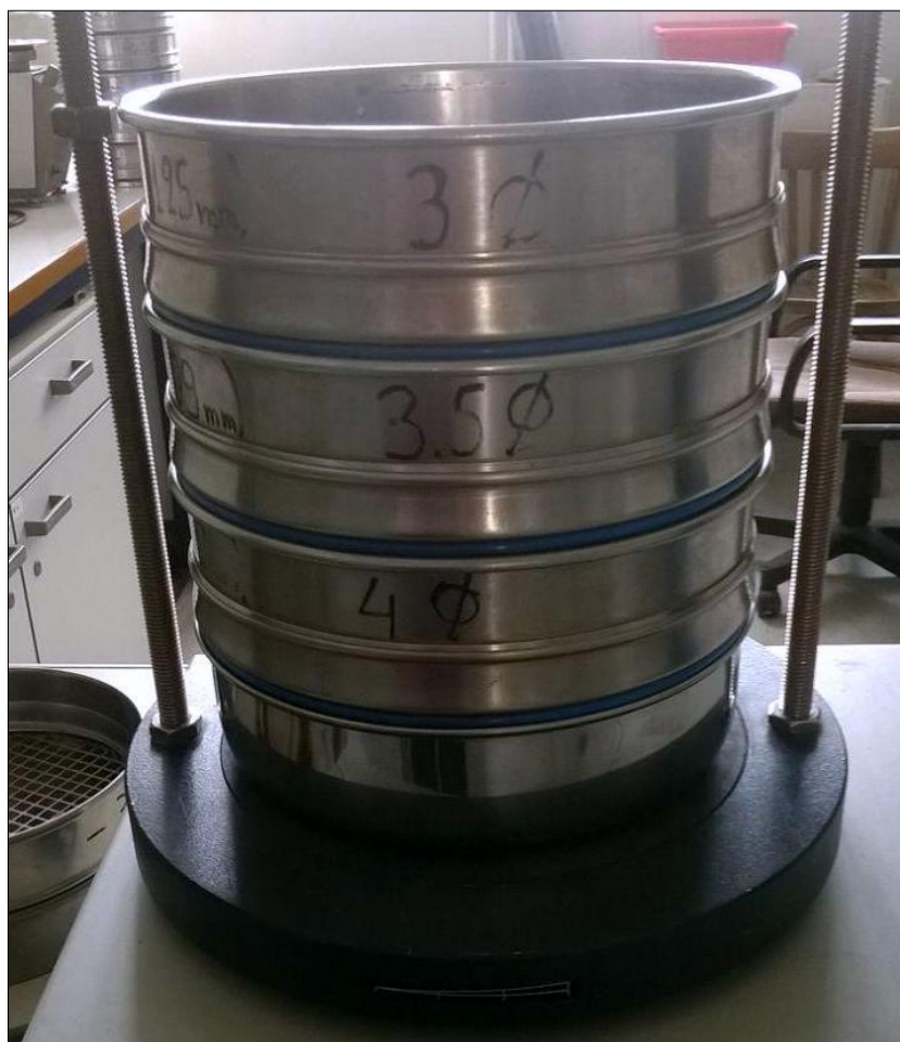
Σχήμα 22. Τα κόσκινα που χρησιμοποιήθηκαν για την μηχανική ανάλυση χοντρόκοκκων υλικών με διάμετρο βροχίδων 4φ, 3.5φ και 3φ.
