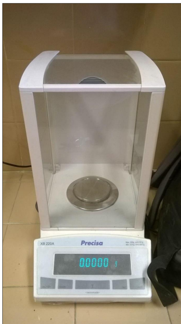
Σχήμα 21. Ζυγαριά ακριβείας που χρησιμοποιήθηκε για τον υπολογισμό του ειδικού βάρους.
