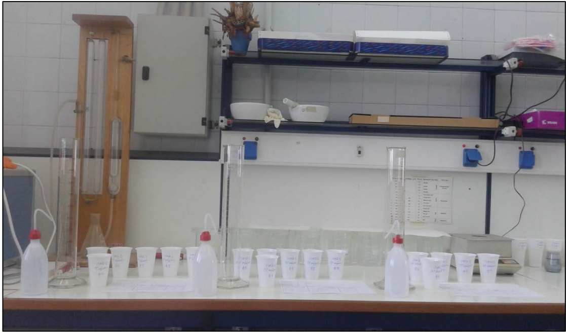
Προετοιμασία εξοπλισμού για τις αναλύσεις των δειγμάτων με τη μέθοδο του σιφωνίου.
