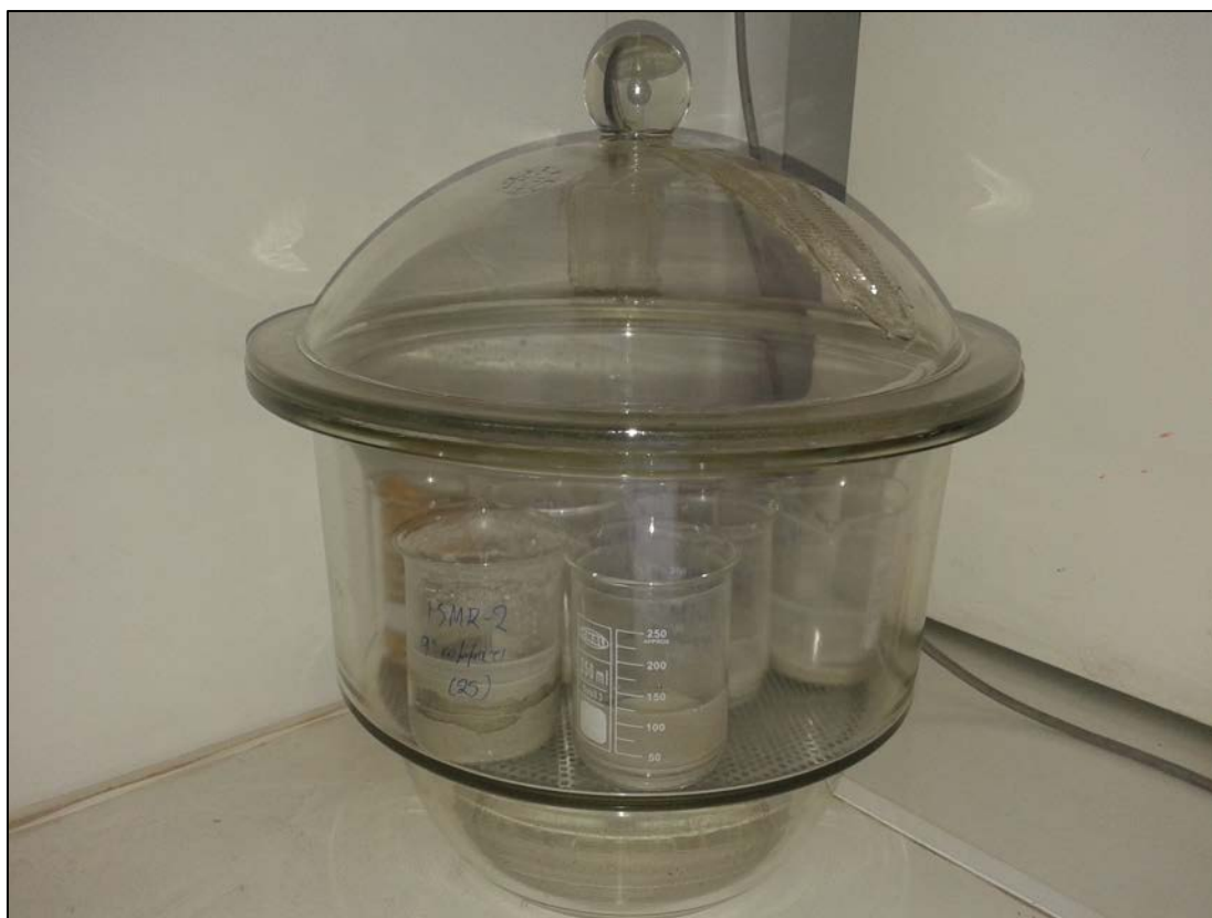
Εικόνα 32: Τοποθέτηση δειγμάτων στον αφυγραντήρα έπειτα από ξήρανση στον φούρνο.
