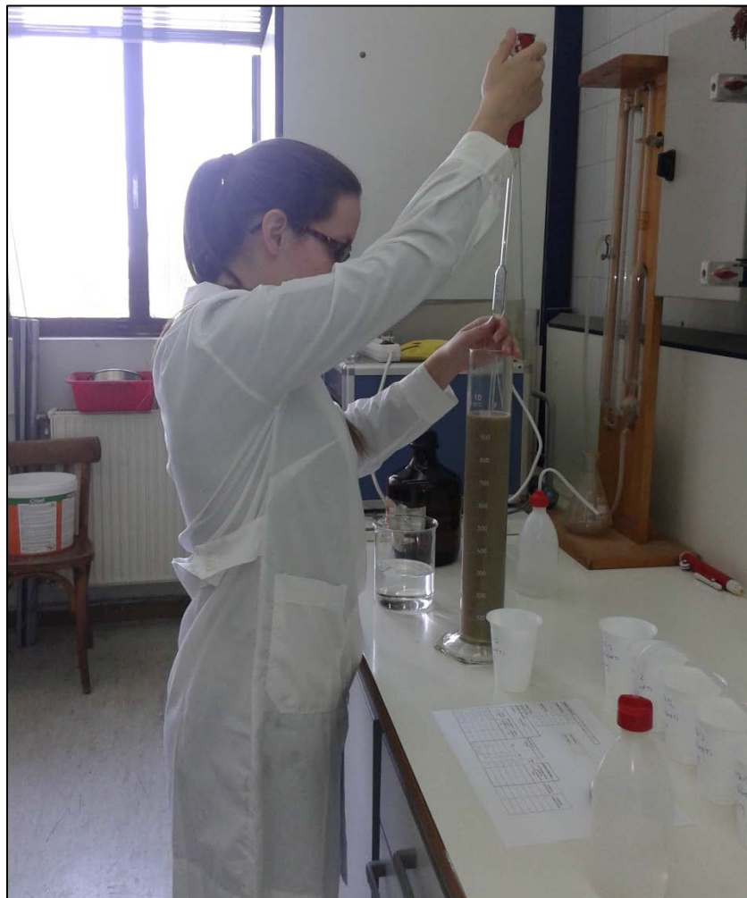
Χρήση πιπέτας - δειγματοληψία υλικού κατά την ανάλυση λεπτόκοκκων ιζημάτων.
