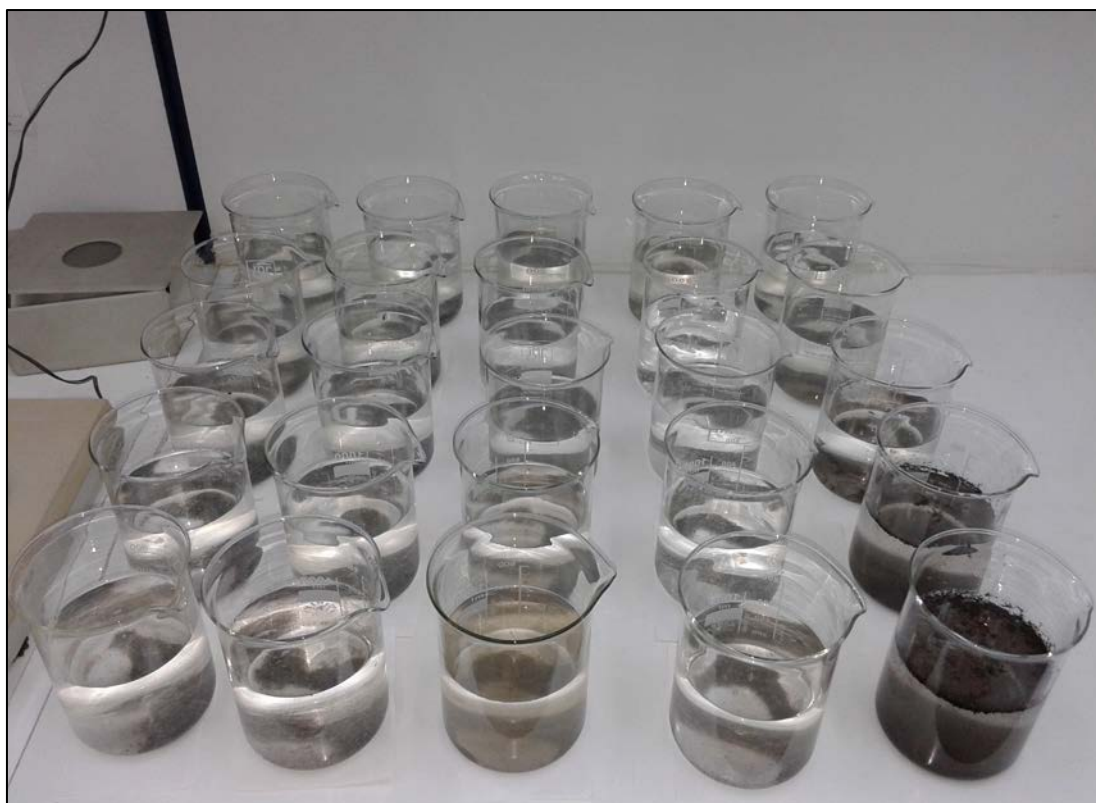
Εικόνα 28: Αποσυσσωμάτωση δειγμάτων με τη χρήση 30% H_2O_2 σε 500 ml κανονικού νερού.
