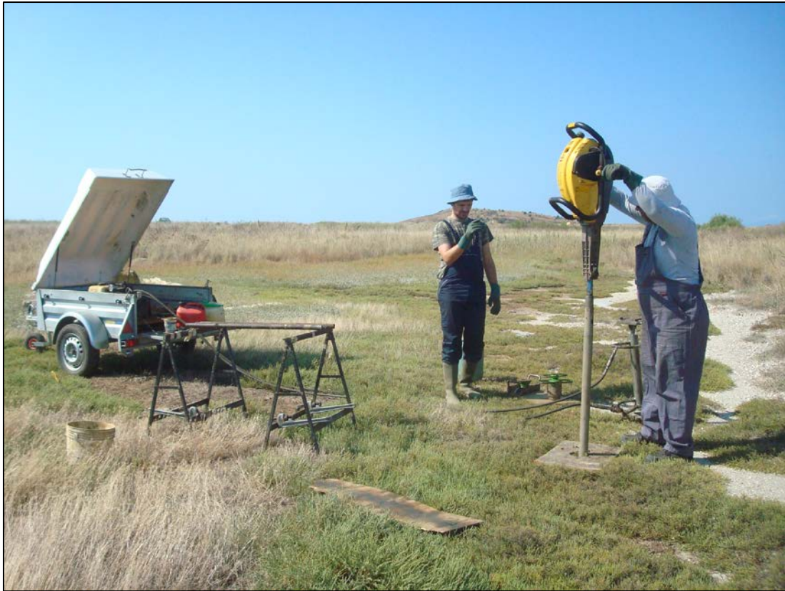
Εικόνα 20: Διάτρηση πυρήνων με κρουστικό γεωτρήπανο Atlas Copco (Cobra MK 1).
