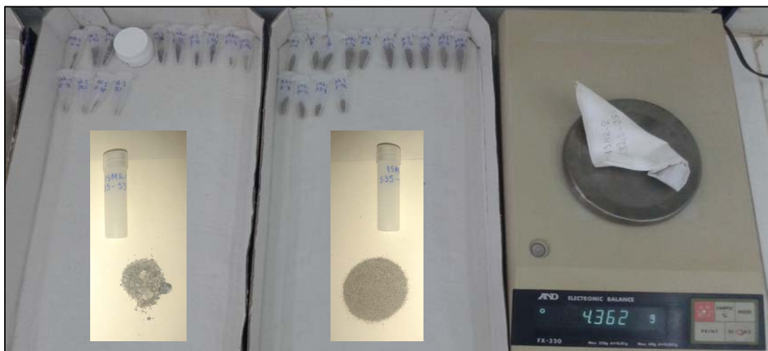
Εικόνα 31: Ζύγιση καθαρού βάρους πλυμένου, αποξηραμένου κλάσματος, διαχωρισμός του σε δύο μέρη σε κόσκινο με πλέγμα διαμέτρου 0,25 mm και αποθήκευσή τους σε φιαλίδια.
