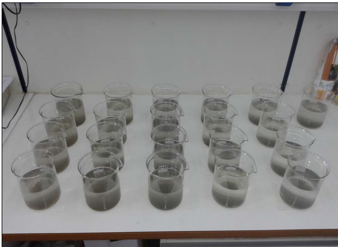
Προσθήκη νερού και H_2O_2 προς αποσυσσωμάτωση των κόκκων.
