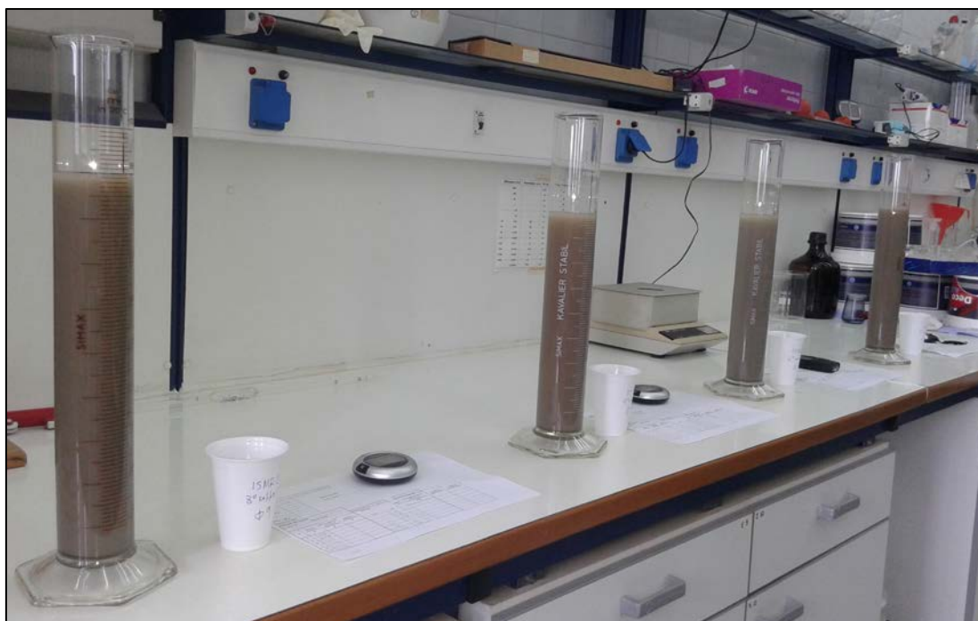
Εικόνα 34: Μηχανική ανάλυση λεπτόκοκκων ιζημάτων με τη μέθοδο του σιφωνίου.
