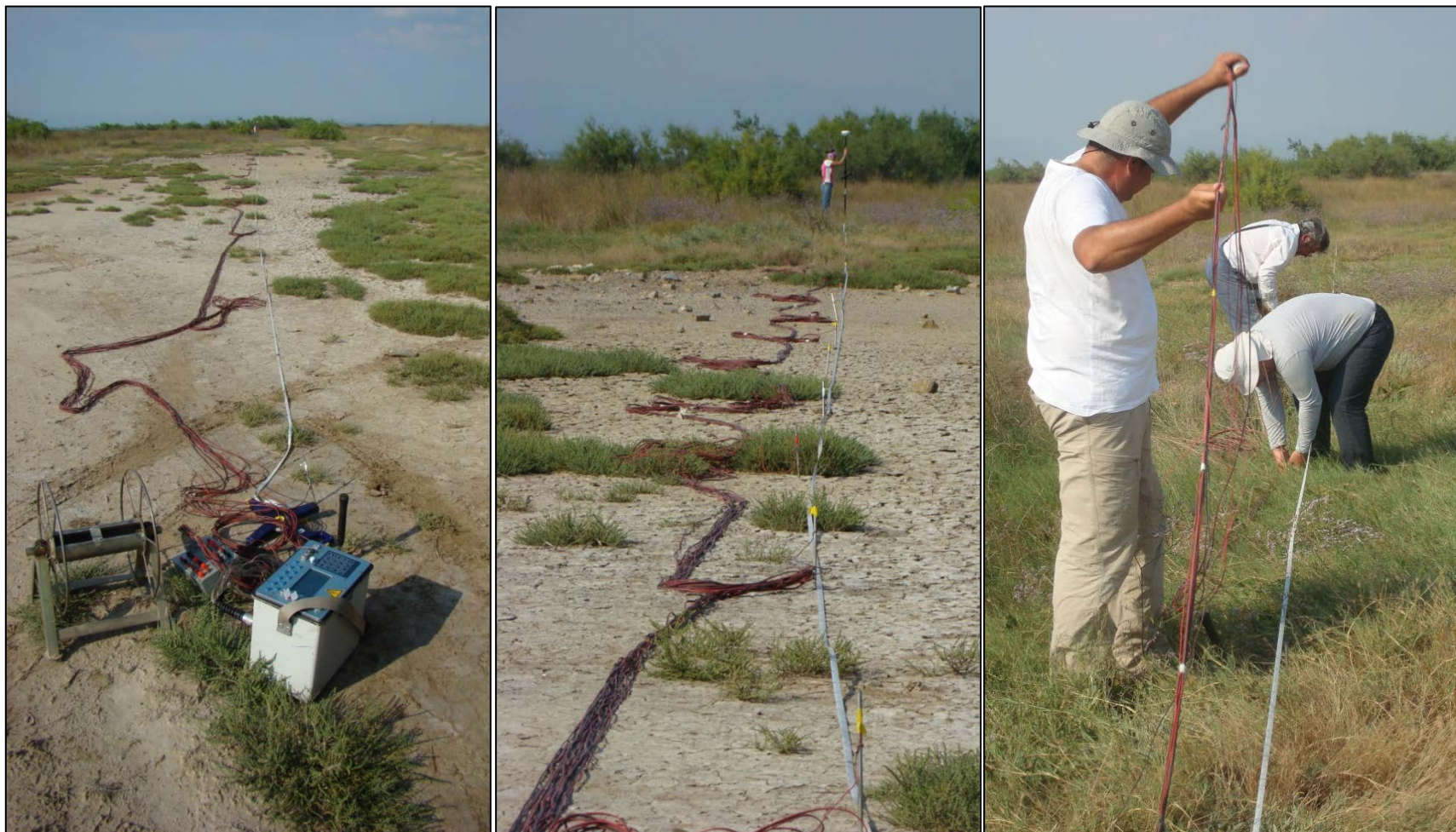
Γεωφυσική διασκόπηση στην περιοχή μελέτης με βήμα ηλεκτροδίων 4 m.
