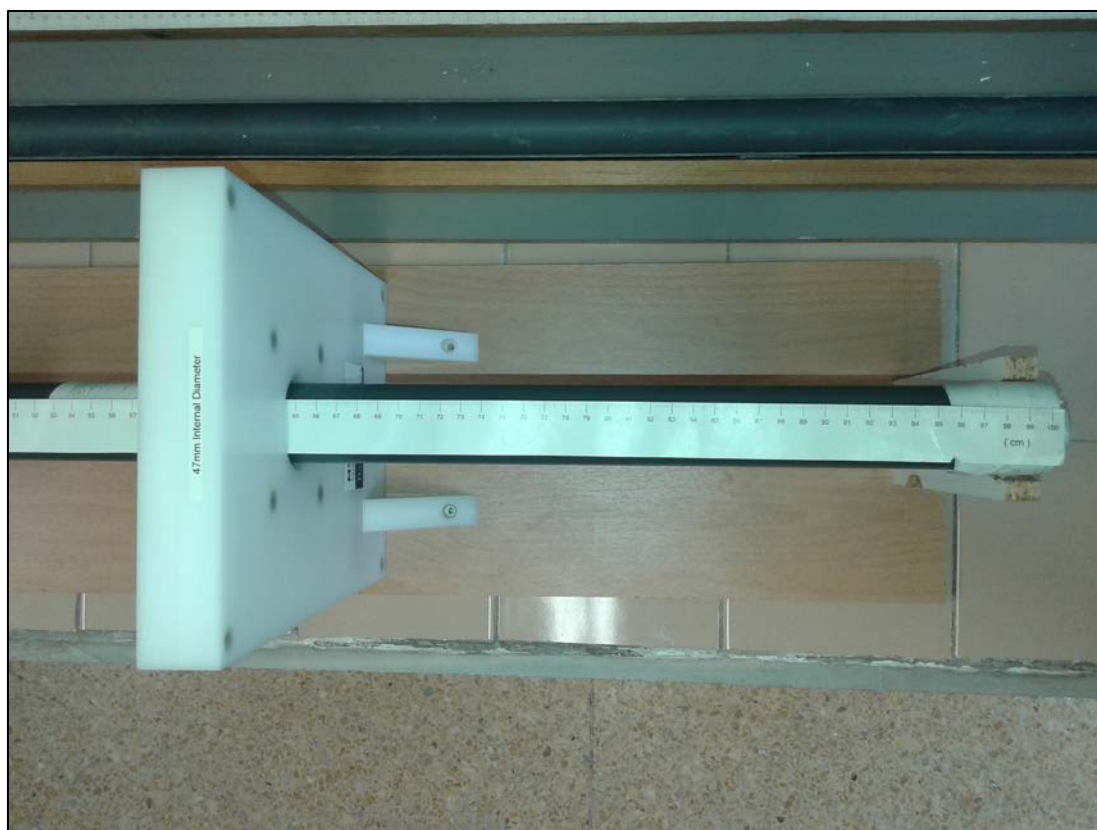
Εικόνα 22: Μέτρηση βαθμού μαγνήτισης των ιζημάτων με τη συσκευή MS2C Core Logging Sensor Ring Sensor.
