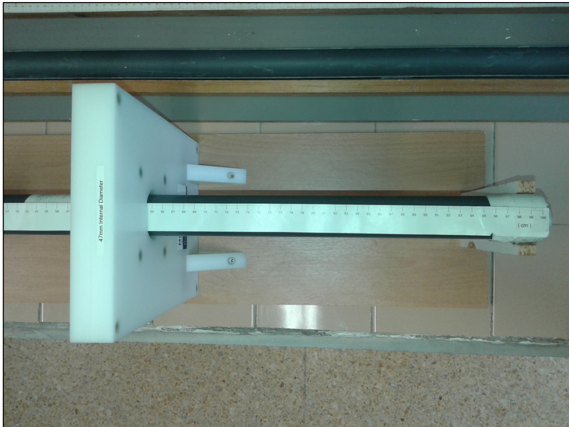
Μέτρηση μαγνητικής επιδεκτικότητας πυρήνων της γεώτρησης ISMR-2.
