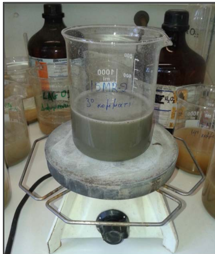
Καύση οργανικών υπολειμμάτων κάθε δείγματος προς ιζηματολογική ανάλυση με H_2O_2 , σε θερμαινόμενη εστία και έλεγχος ολοκλήρωσης αναβρασμού.
