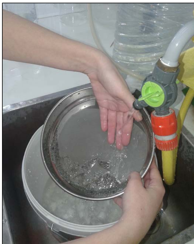
Εικόνα 29: Πλύσιμο δειγμάτων σε ανοξείδωτο κόσκινο με πλέγμα διαμέτρου 0,063 mm.
