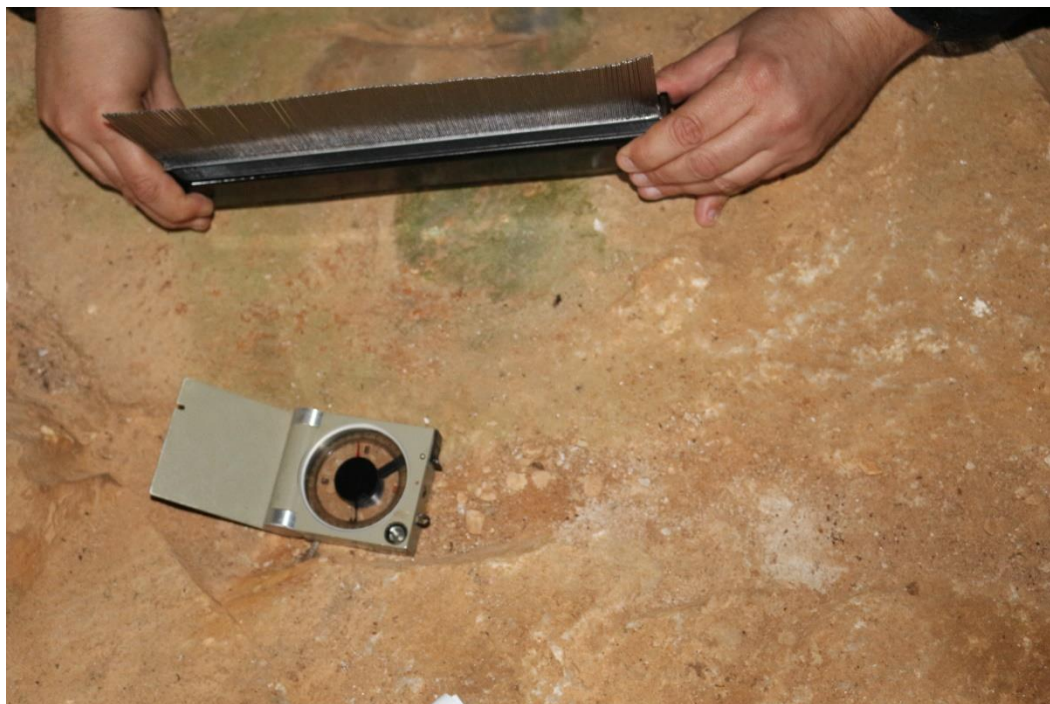
Εικόνα 11. Αποτύπωση προφίλ με τη χρήση προφίλομέτρου στις επιφάνειες των ασυνεχειών του μαρμάρου.
