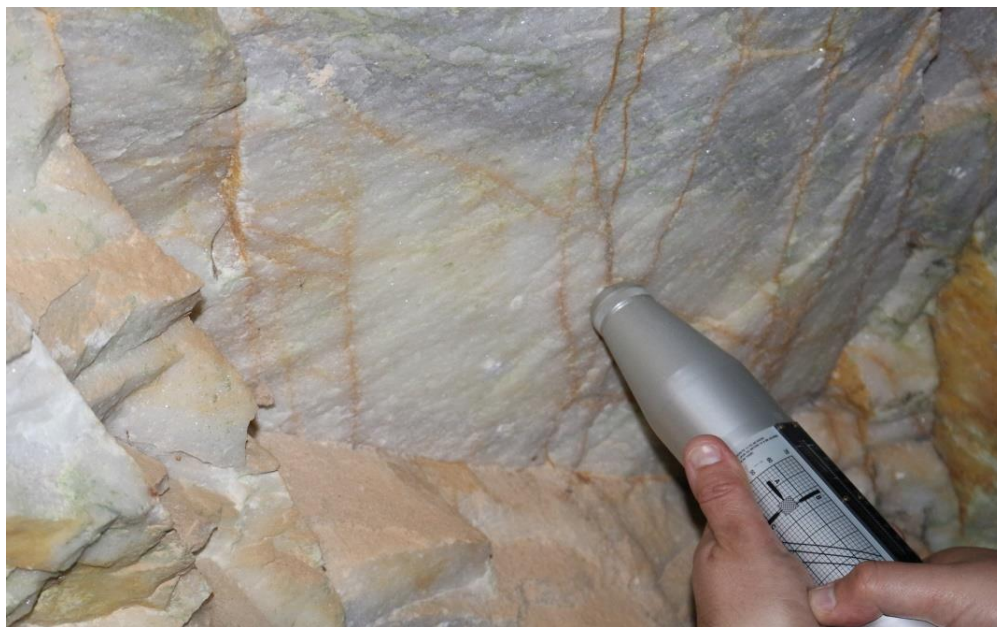
Εικόνα 9. Εκτίμηση μονοαξονικής αντοχής επιφάνειας ασυνέχειας JCS από τις μετρήσεις αναπήδησης Σφύρας Schmidt.
