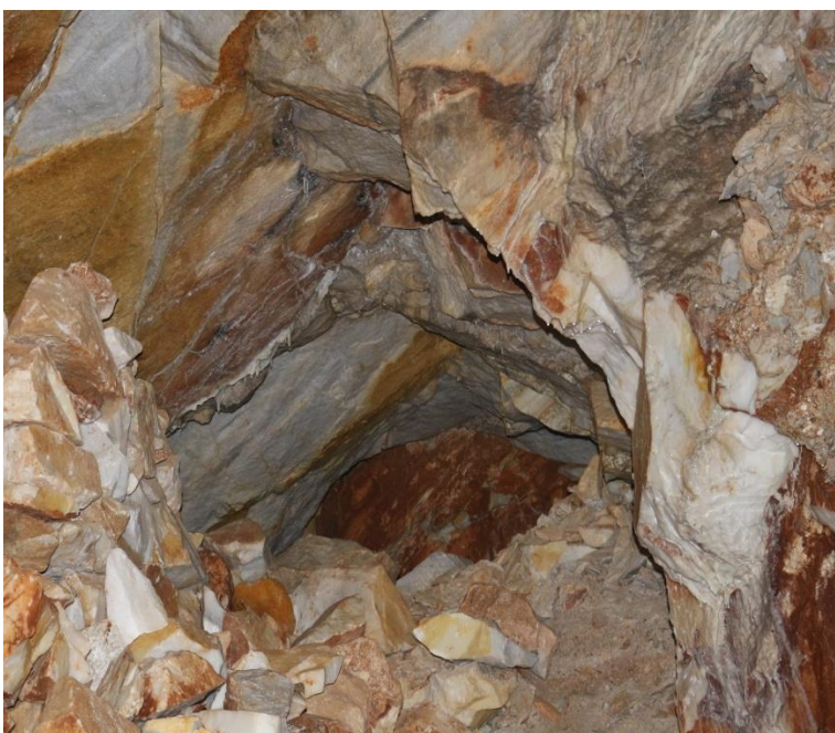
Εικόνα 12. Πρώτος τύπος. Τεμαχώδης με καλή ποιότητα ασυνεχειών (τραχείες, ελαφρά αποσαθρωμένες και οξειδωμένες επιφάνειες) και τιμή GSI 65.
