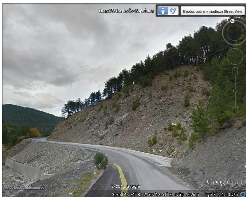
Εικόνα 1.6 Εντοπισμός της κατολίσθησης (Θέση 18) στο δεξί μέρος του δρόμου, με τη χρήση του Street View.
