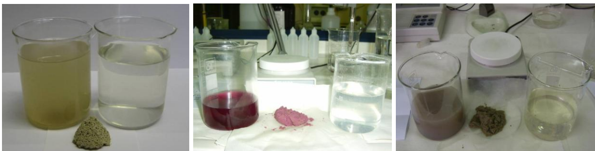
Σχήμα 3.1. Αστικά λύματα, υγρά απόβλητα βαφείου και υγρά απόβλητα βυρσοδεψείου πριν και μετά την κατεργασία με πολύ υψηλής ποιότητας ζεολιθικό τόφο, καθώς και οι παραγόμενες ζεο-λυματολάσπες και ζεο-λάσπες (Φιλιππίδης 2007, Φιλιππίδης κ.α. 2007γ, 2008γ, Filippidis 2008).
