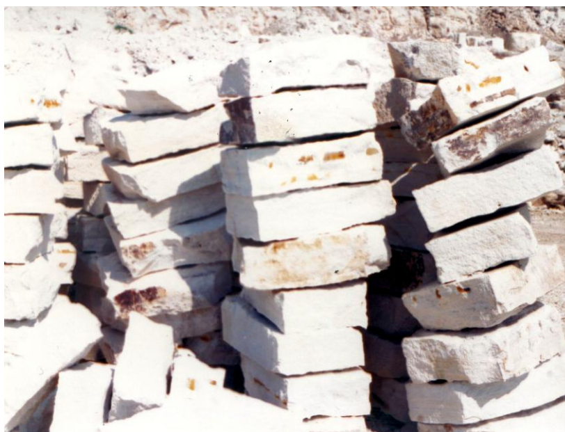
Σχήμα 4.1. Φωτογραφία δομικών λίθων από ζεολιθικό τόφφο (χαμηλής ποιότητας, 57% κλινοπιτόλιθος-ευλανδίτης) του Γουρουνορέματος Μεταξάδων-Αβδέλλας του Νομού Έβρου (Φιλίππιδης 2011)
