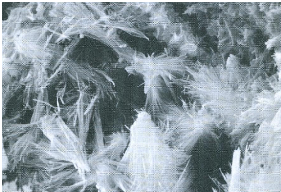
Σχήμα 2.2. Ινώδης μορντενίτης. Μικροφωτογραφία σαρωτικού ηλεκτρονικού μικροσκοπίου (SEM), Οριζόντια διάσταση 1cm (Gottardi & Galli 1985).
