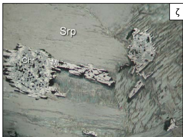
Εικόνα 8. Μικροφωτογραφίες μεταλλικών ορυκτών, στο ανακλώμενο φως, από τους δουνίτες της περιοχής Στρατονίκης : α-β) Ιδιόμορφοι κρύσταλλοι σπινελλίων σε παραγένεση με σουλφίδια, ΜΔΦ: 2mm. γ) Κρύσταλλος σπινελλίου περιβάλλεται από σιδηροπυρίτη που περιέχει εγκλείσματα μαγνητοπυρίτη και πεντλανδίτη, ΜΔΦ: 1mm. δ) Συμφυση χρωμίτη με μαγνητίτη. Παρατήρηση σε ελαιοκατάδυση, ΜΔΦ: 1mm. ε) Ζωνώδεις κρύσταλλοι σπινελλίων σε επαφή με σιδηροπυρίτη που παρουσιάζει μετατροπή σε λειμωνίτη, ΜΔΦ: 1mm. ζ) Ζωνώδεις κρύσταλλοι σπινελλίων και μαγνητίτης σε αντιγορίτη. Παρατήρηση σε ελαιοκατάδυση, ΜΔΦ: 1mm. (Συμβολισμός: Chr: χρωμίτης, FChr: σιδηροχρωμίτης, Mt: μαγνητίτης, Py: σιδηροπυρίτης, Pn: πεντλανδίτης, Po:μαγνητοπυρίτης, Lm: λειμωνίτης, Ol: ολιβίνης, Srp: σερπεντίνης, ΜΔΦ: μεγάλη διάσταση φωτογραφίας).
