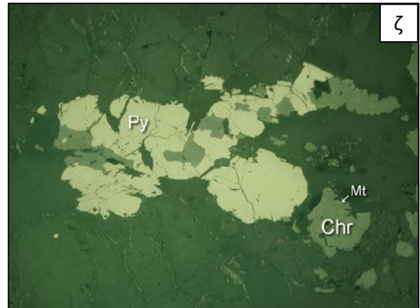
Εικόνα 9. Μικροφωτογραφίες μεταλλικών ορυκτών στο ανακλώμενο φως από τους δουνίτες της περιοχής Στρατονίκης, Ν- : α) Απόμειξη πεντλανδίτη σε σιδηροπυρίτη. Παρατήρηση σε ελαιοκατάδυση, ΜΔΦ: 1mm. β) Σύνθετος κόκκος που αποτελείται από σιδηροπυρίτη με απομεικτικά σώματα πεντλανδίτη και μιλλερίτη. Παρατήρηση σε ελαιοκατάδυση, ΜΔΦ: 1mm. γ) Σύμφυση χρωμίτη που περιβάλλεται από μαγνητίτη και απόμειξη σιδηροπυρίτη που περικλείει πεντλανδίτη, μαζί μέσα σε τάληκη. Παρατήρηση σε ελαιοκατάδυση, ΜΔΦ: 1mm. δ) Σιδηροπυρίτης με βελόνες πεντλανδίτη που εγκλείει σώματα μιλλερίτη. Παρατήρηση σε ελαιοκατάδυση, ΜΔΦ: 1mm. ε-ζ) Γενική εικόνα μεταλλοφορίας στους δουνίτες της περιοχής Στρατονίκης, ΜΔΦ: 2mm. (Συμβολισμός: Chr: χρωμίτης, Mt: μαγνητίτης, Py: σιδηροπυρίτης, Pn: πεντλανδίτης, Ccp: χαλκοπυρίτης, Mlr: μιλλερίτης, Srp: σερπεντίνης, Chl: χλωρίτης, ΜΔΦ: μεγάλη διάσταση φωτογραφίας).
