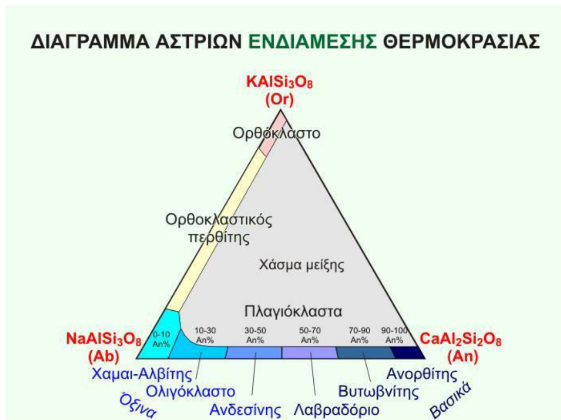
Σχήμα 5.11 . Τριαδικό σύστημα Ορθόκλαστου-Αλβίτη-Ανορθίτη (Or-Ab-An) ενδιάμεσης θερμοκρασίας σχηματισμού.
