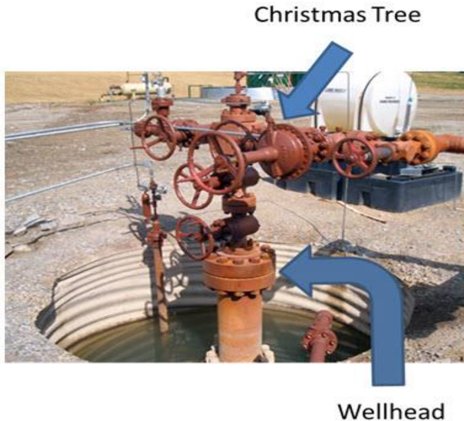
Εικόνα 18: Απεικόνιση της κεφαλής ανάβλυσσης Christmas tree και Wellhead. (29)
