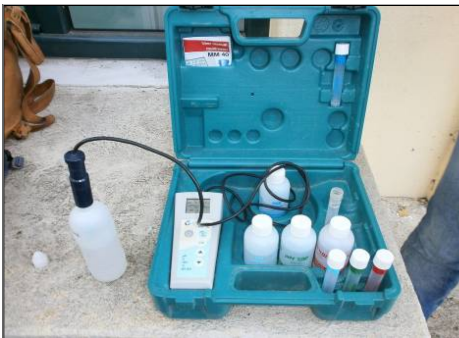
Φωτ. 6.1 Όργανα μέτρησης φυσικοχημικών παραμέτρων των δειγμάτων.
