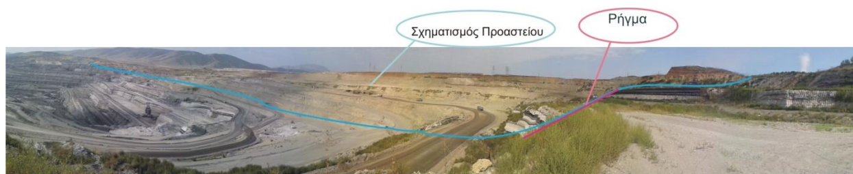
Σχήμα 8: Επαφή του σχηματισμού Προαστείου με τον υποκείμενο σχηματισμό Πτολεμαΐδας στο ορυχείο Μαυροπηγής.
