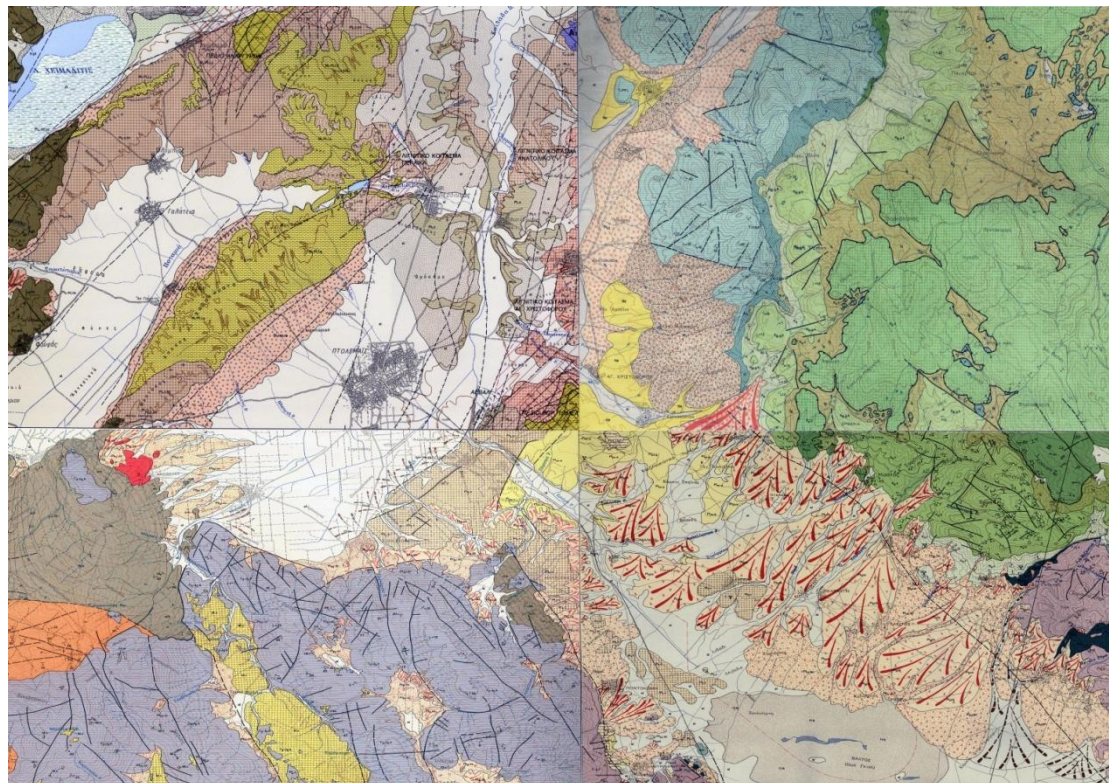
Σχήμα 4: Γεωλογικός χάρτης της περιοχής μελέτης με συνένωση 4 γεωλογικών φύλλων του ΙΓΜΕ. Με κίτρινο χρώμα και με κόκκινο στο πάνω αριστερό και κροκάλες εμφανίζεται ο σχηματισμός Προαστείου.
