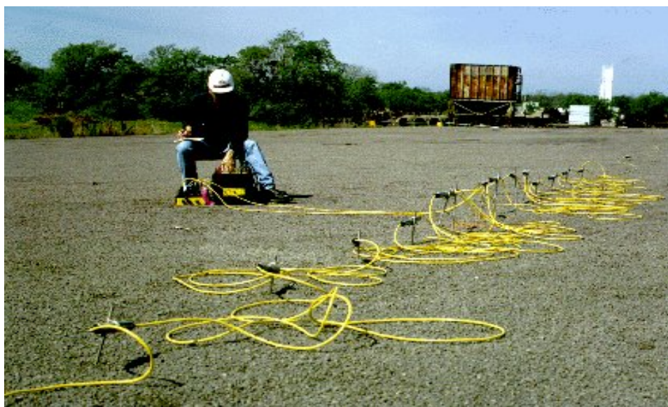
Σχήμα 2.2 Πολυκάναλο σύστημα λήψης μετρήσεων ηλεκτρικής τομογραφίας
