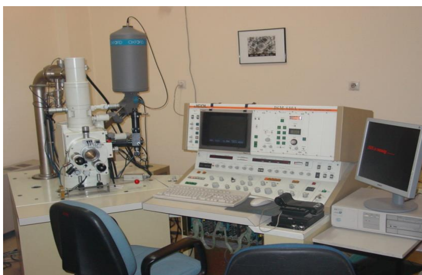
Εικόνα 59. Σύστημα ηλεκτρονικού μικροσκοπίου σάρωσης (SEM) τύπου Jeol JSM-840 εφοδιασμένο με σύστημα ανάλυσης της διασποράς ενέργειας (EDS)
