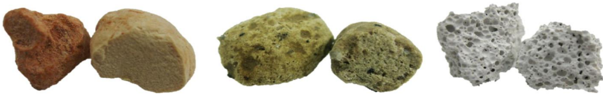
Εικόνα 60. Ελαφροβαρή αδρανή υλικά. Από αριστερά προς δεξιά: Διατομίτης, Ελαφρόπετρα, Επεξεργασμένο σκυρόδεμα (Zaetang et al. 2013).
