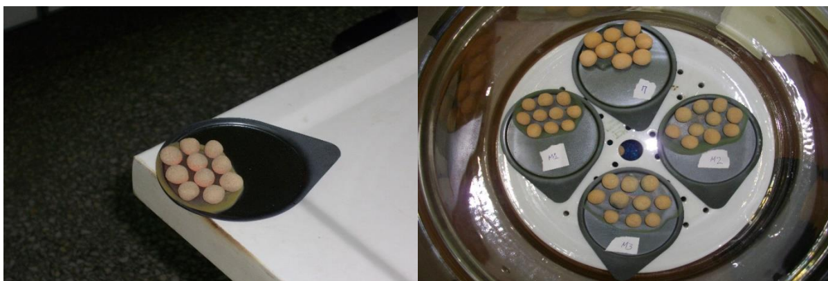
Εικόνα 67. Σφαιρίδια μίγματος (M2) ύστερα από όπτηση στους 1050 °C και διατήρηση όλων των σφαιριδίων στον αφυγραντή.
