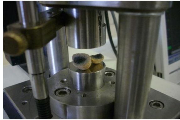
Εικόνα 70. Διαδικασία θραύσης σφαιριδίου μίγματος M1 (δείγμα M1.21) ύστερα από όπτηση στους 950 °C.
