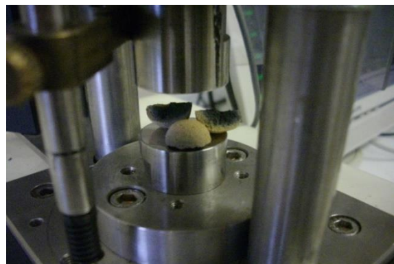
Εικόνα 71. Διαδικασία θραύσης σφαιριδίου μίγματος M2 (δείγμα M2.11) ύστερα από όπτηση στους 1050 °C.
