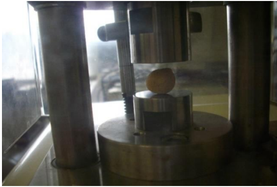
Εικόνα 70. Διαδικασία θραύσης σφαιριδίου μίγματος M1 (δείγμα M1.21) ύστερα από όπτηση στους 950 °C.
