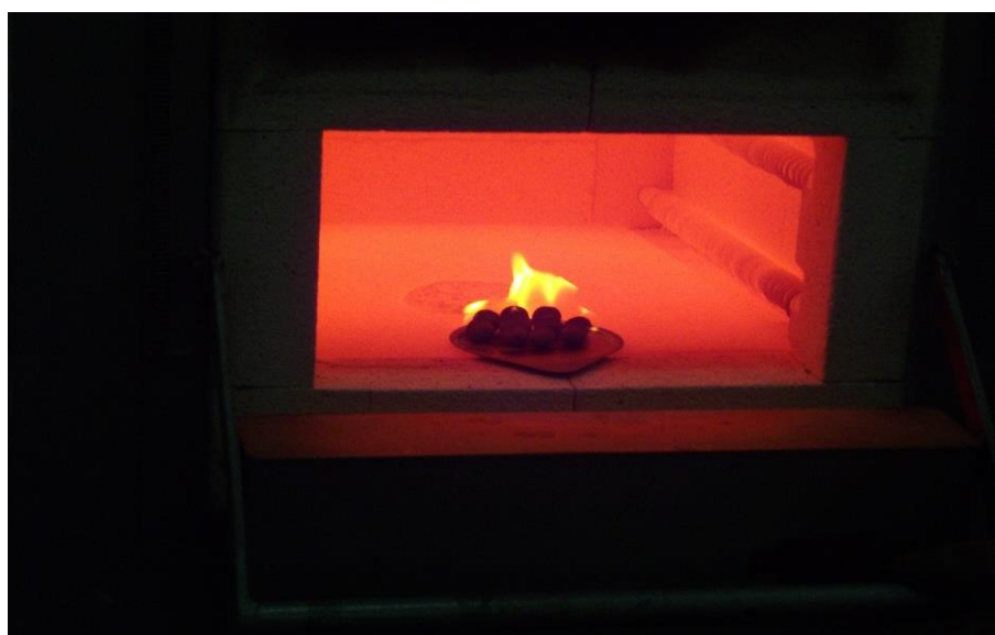
Εικόνα 65. Διαδικασία όπτησης των μορφοποιημένων σφαιριδίων. Διακρίνεται η καύση του ελαιοπυρήνα.
