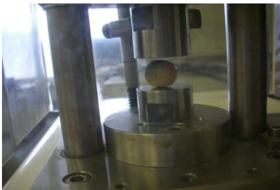
Εικόνα 71. Διαδικασία θραύσης σφαιριδίου μίγματος M2 (δείγμα M2.11) ύστερα από όπτηση στους 1050 °C.
