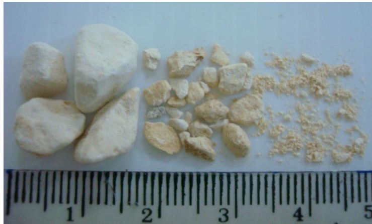
Εικόνα 61. Διατομίτης ως προϊόν κατασκευής ελαφροβαρών αδρανών υλικών (Posi et al. 2013).
