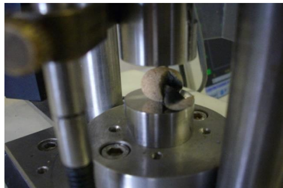
Εικόνα 72. Διαδικασία θραύσης σφαιριδίου μίγματος M3 (δείγμα M3.11) ύστερα από όπτηση στους 1150 °C.
