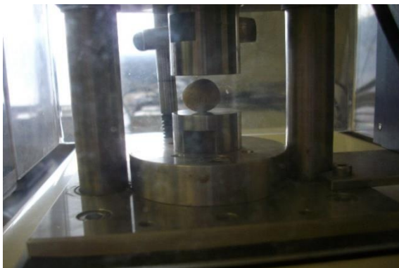
Εικόνα 72. Διαδικασία θραύσης σφαιριδίου μίγματος M3 (δείγμα M3.11) ύστερα από όπτηση στους 1150 °C.
