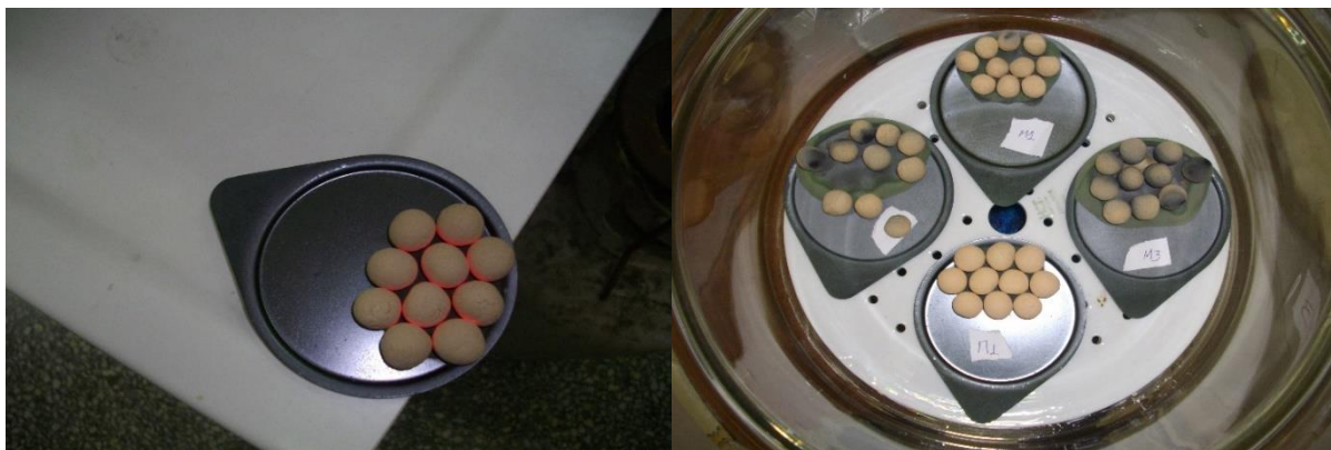
Εικόνα 66. Σφαιρίδια μίγματος (M1) ύστερα από όπτηση στους 950 °C (αριστερά) και διατήρηση όλων των σφαιριδίων στον αφυγραντή (δεξιά).
