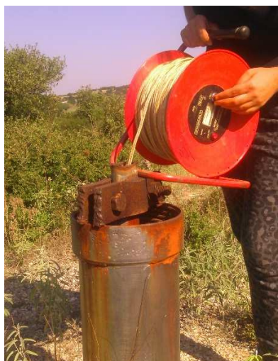
Εικόνα 6. Μετρήσεις στην ύπαιθρο με τη βοήθεια του σταθμημέτρου.
