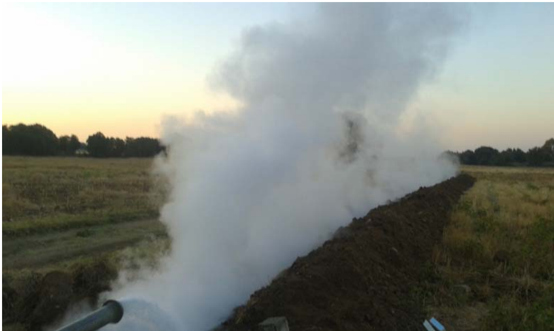
Εικόνα 4: Δοκιμαστική άντληση διαρκείας σε πλήρη εξέλιξη. Παροχή 90-100 m 3 /h και T=89,3°C.
