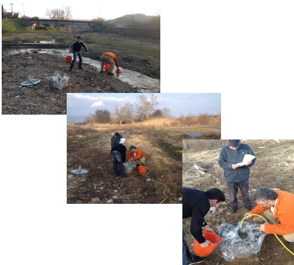
Εικόνα 6.2 Διαδικασία αρχικής πλήρωσης του διηθητόμετρου με νερό
