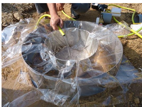
Εικόνα 2.1. Διαδικασία εισαγωγής νερού με τη βοήθεια νάιλον και καταγραφή της πτώσης στάθμης με χάρακα.
