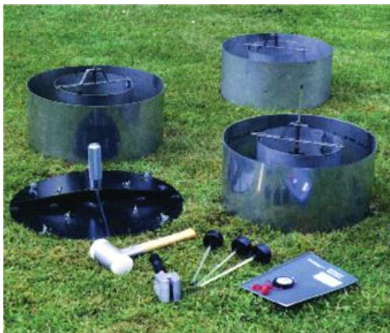
Σχήμα 2.2. Το διηθητόμετρο διπλού δακτυλίου (Πηγή: www.waqtechprojects.com )
