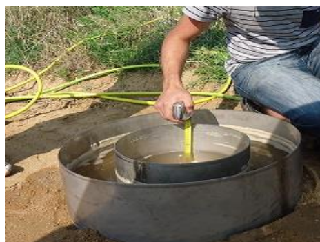
Εικόνα 2.1. Διαδικασία εισαγωγής νερού με τη βοήθεια νάιλον και καταγραφή της πτώσης στάθμης με χάρακα.
