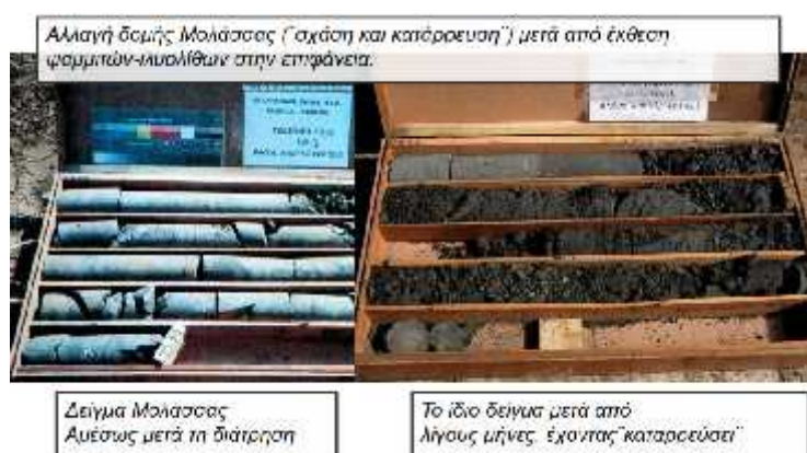
Εικόνα 31. Η σχάση που έχουν υποστεί οι πυρήνες μετά από την αποθήκευσή τους. (Μαρίνος Β. 2007).
