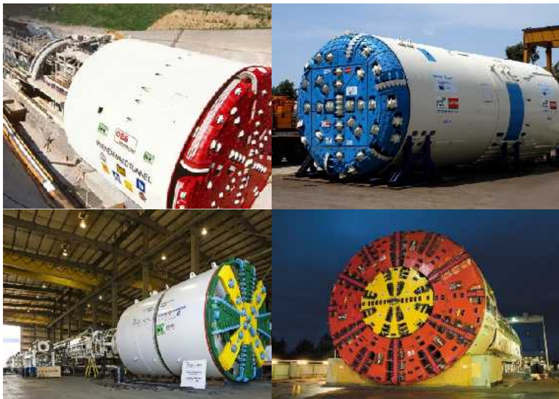
Εικόνα 14. Μηχανήματα TBM. Πάνω αριστερά: Μηχάνημα μονής ασπίδας (Single Shield TBM), πάνω δεξιά: Μηχάνημα Διπλής Ασπίδας (Double Shield TBM), κάτω αριστερά: Μηχάνημα Ασπίδας Πολφού (Slurry Shield TBM), κάτω δεξιά: Μηχάνημα Εξισορρόπησης Πίεσης (EPB Machine). (Μαρίνος Β. 2007).
