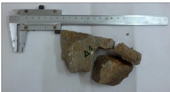
Εικόνα 46 Δοκιμή σημειακής φόρτισης σε δείγμα γνευσίου, φωτογραφίες από Triger Γεωλόγοι-Σύμβουλοι
