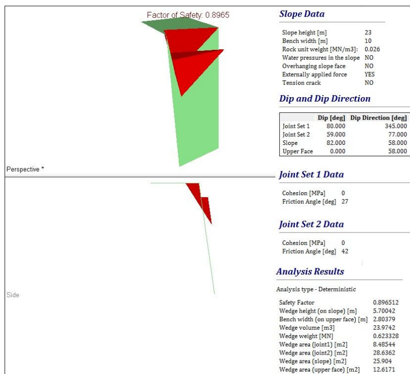
Εικόνα 94 Σφηνοειδής αστοχία για στατικές-ξηρές συνθήκες
