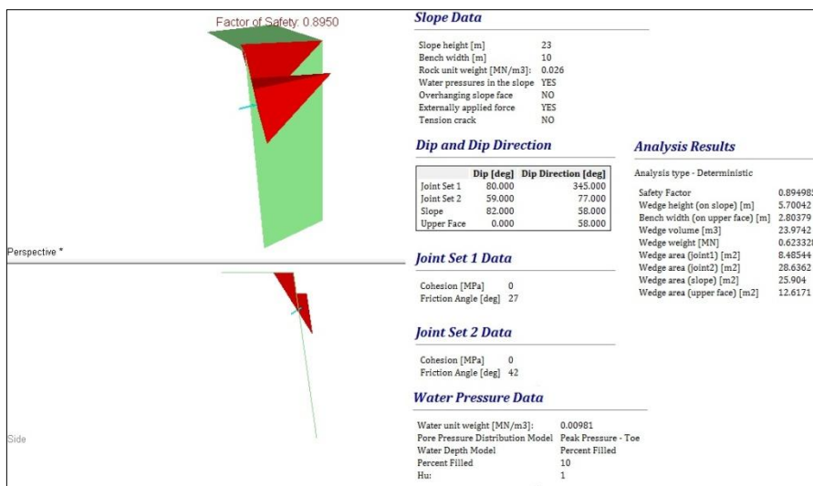
Εικόνα 96 Σφηνοειδής αστοχία για στατικές-υγρές συνθήκες
