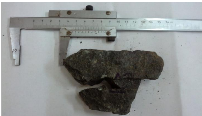
Εικόνα 45 Δοκιμή σημειακής φόρτισης σε δείγμα αμφιβολίτη, φωτογραφίες από Triger Γεωλόγοι-Σύμβουλοι
