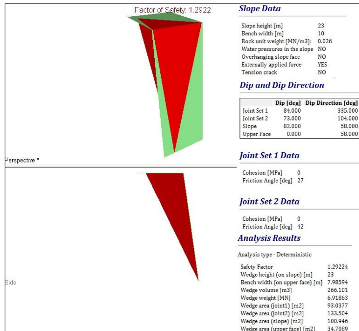
Εικόνα 99 Σφηνοειδής αστοχία για στατικές-ξηρές συνθήκες
