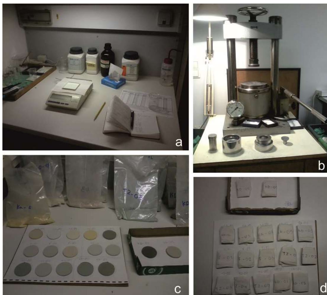
Σχήμα 28. Στάδια κατασκευής δισκίων συμπιεσμένης σκόνης (pressed pellets). a) Ζυγαριά ακριβείας, b) υδραυλική πρέσα, c) Δισκία πριν το φούρνο, d) Δισκία μετά τα φούρνο, τυλιγμένα και έτοιμα για ανάλυση.
