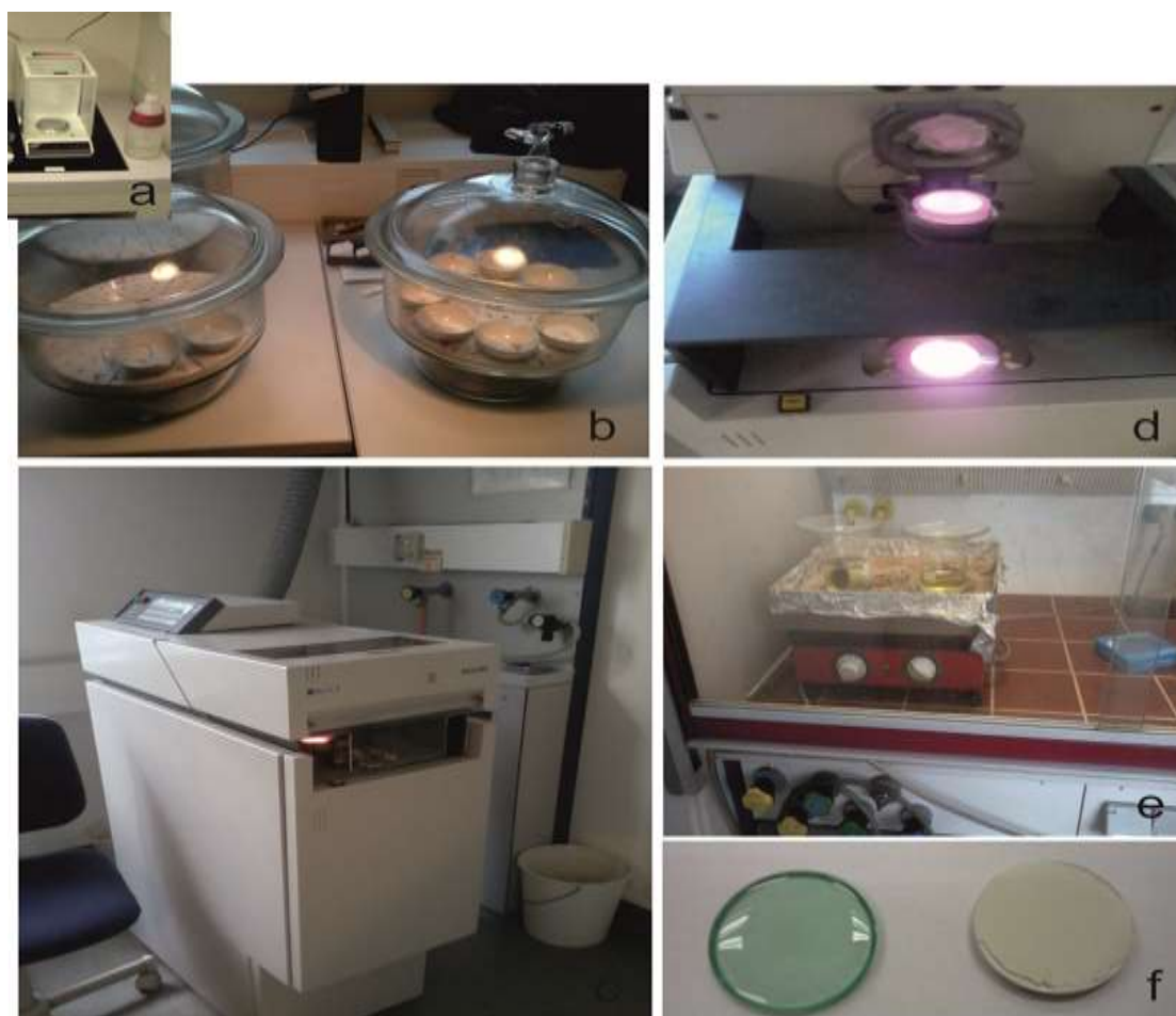
Σχήμα 29. Επιμέρους στάδια κατασκευής υαλοποιημένων δισκίων (fused beads). a) Ζυγαριά ακριβείας, b) Αεροστεγώς σφραγισμένα δοχεία προσωρινής αποθήκευσης των δειγμάτων, c) Perl-X, d) θερμαντική πηγή που προκαλεί την τήξη του δείγματος, e) διάλυμα Νιτρικού οξέως για καθαρισμό των δοχείων, f) υαλοποιημένα δισκία και δισκία συμπιεσμένης σκόνης.
