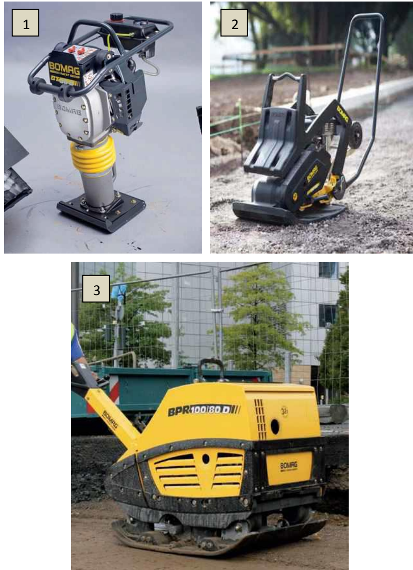
Σχήμα 4.28: Ευέλικτα μηχανήματα συμπίκνωσης: 1) Βάτραχος βάρους 50 έως 80 kg, 2) Ελαφρά δονητική πλάκα μιας κατεύθυνσης, βάρους 40 έως 150 kg και 3) Βαριά δονητική πλάκα διπλής κατεύθυνσης βάρους 120 έως 800 kg.
