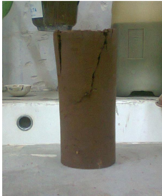
Φωτογραφία 6: Θραύση δοκιμίου σε ανεμπόδιστη θλίψη (UCS), αντοχή σε ανεμπόδιστη θλίψη q_u = 84.5 \text{ kPa} ( c_u = 42.25 \text{ kPa} ).
