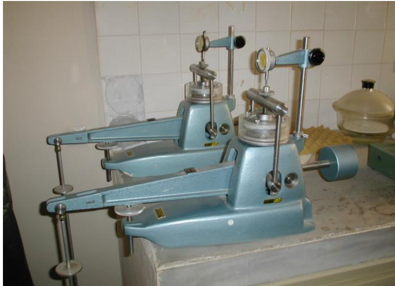
Φωτογραφία 5: Συσκευή οιδημέτρου.
