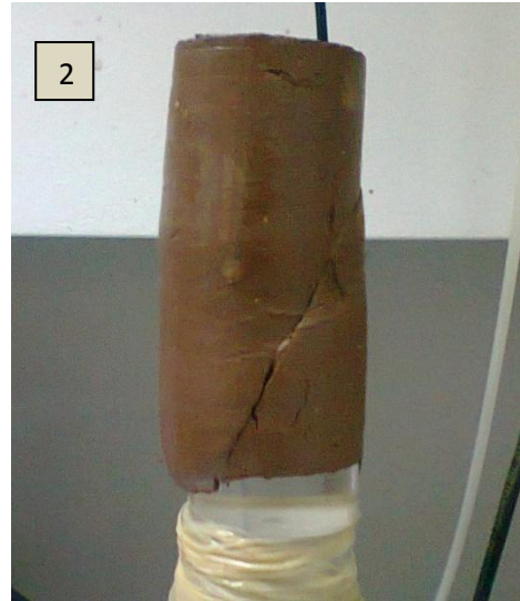
Φωτογραφία 7: Θραύση δοκιμίων 1 και 2 σε UU τριαξονική δοκιμή. Παρατηρούμε πως οι γωνίες του επιπέδου θραύσης είναι ίδιες αλλά αντίθετης φοράς.
