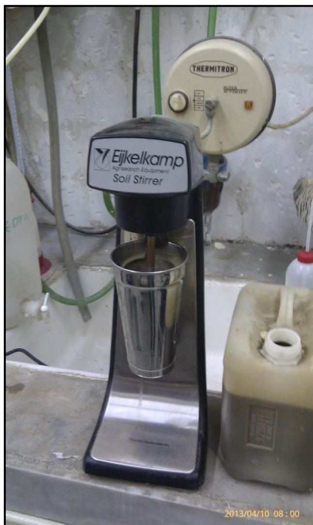
Σχήμα 5.9: Μηχανική συσκευή ανακίνησης (mixer)
