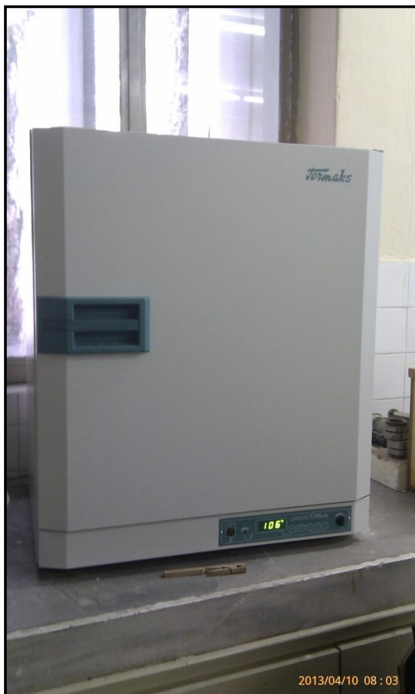
Σχήμα 5.6: Φούρνος στον οποίο θερμαίνεται το δείγμα
