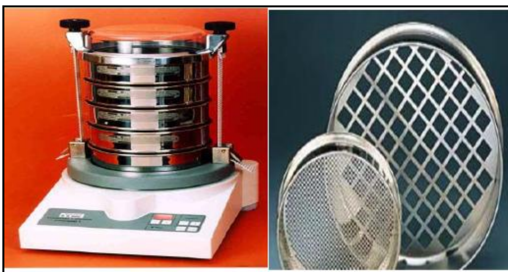
Σχήμα 5.3: Συσκευή κοσκίνισματος και κόσκινα
