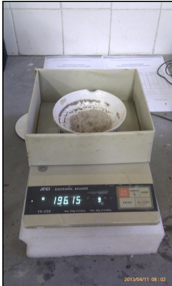
Σχήμα 5.5: Ζυγαριά ακριβείας (μέσα βρίσκεται το εδαφικό υλικό μετά τη ξήρανσή του)
