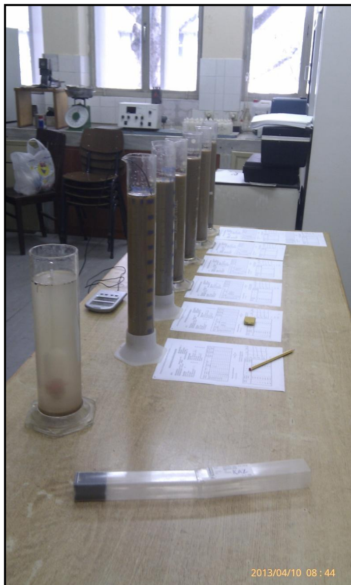
Σχήμα 5.10 : Ογκομετρικοί κύλινδροι που περιέχουν το εδαφικό αιώρημα
