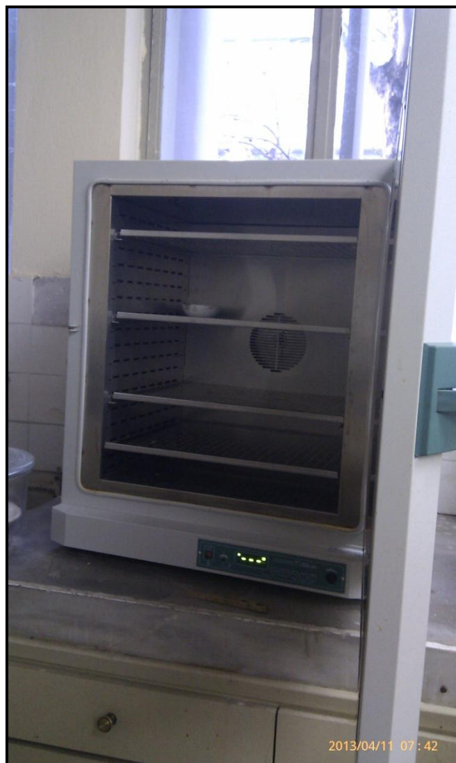
Σχήμα 5.7: Φούρνος στον οποίο θερμαίνεται το δείγμα
