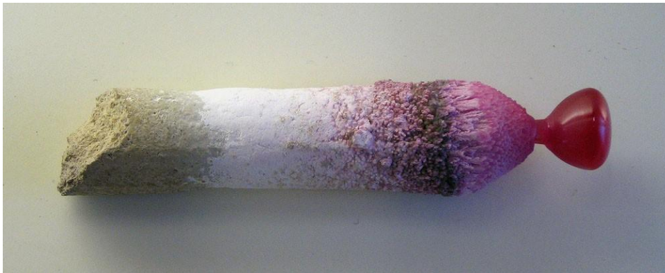
Εικόνα 5: Ένα μικρό ρουμπίνι boule που παράγεται με τη μέθοδο Verneuil και εξακολουθεί να συνδέεται με τη ράβδο . ( https://en.wikipedia.org/wiki/Verneuil_process )
