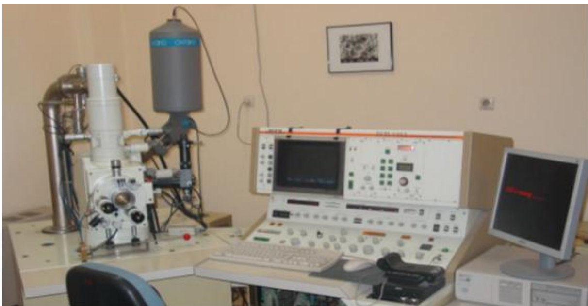
Εικόνα 16. Σαρωτικό ηλεκτρονικό μικροσκόπιο του εργαστηρίου ηλεκτρονικής μικροσκοπίας του Α.Π.Θ.
