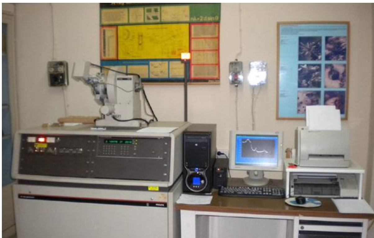
Εικόνα 15. Περιθλασίμετρο του Τομέα Ορυκτολογίας-Πετρολογίας-Κοιτασματολογίας.
