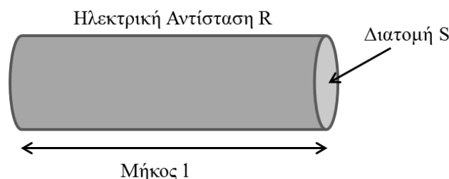
Σχήμα 2.1: Ειδική ηλεκτρική αντίσταση ενός κυλίνδρου ηλεκτρικής αντίστασης R , μήκους l και διατομής S .
