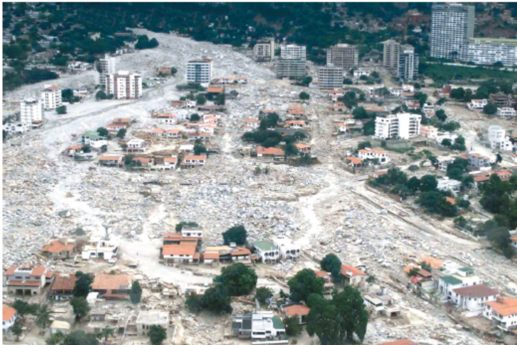
Εικόνα 1.11: Ζημιές από ροές κορημάτων στην πόλη της Caraballeda, που βρίσκεται στη βάση της Cordillera de laCostân, στη βόρεια ακτή της Βενεζουέλας. Τον Δεκέμβριο του 1999, η περιοχή χτυπήθηκε από τη χειρότερη φυσική καταστροφή του 20ου αιώνα για την Βενεζουέλα. Αρκετές ημέρες καταρρακτώδους βροχής ενεργοποίησαν ροές από λάσπη, πέτρες, νερό, και δέντρα με αποτέλεσμα να σκοτωθούν περισσότερα από 30.000 άτομα. . (Φωτογραφία από τον L.M. Smith, Waterways Experiment Station, U.S. Army Corps of Engineers, (Highland & Bobrowsky, 2008))
