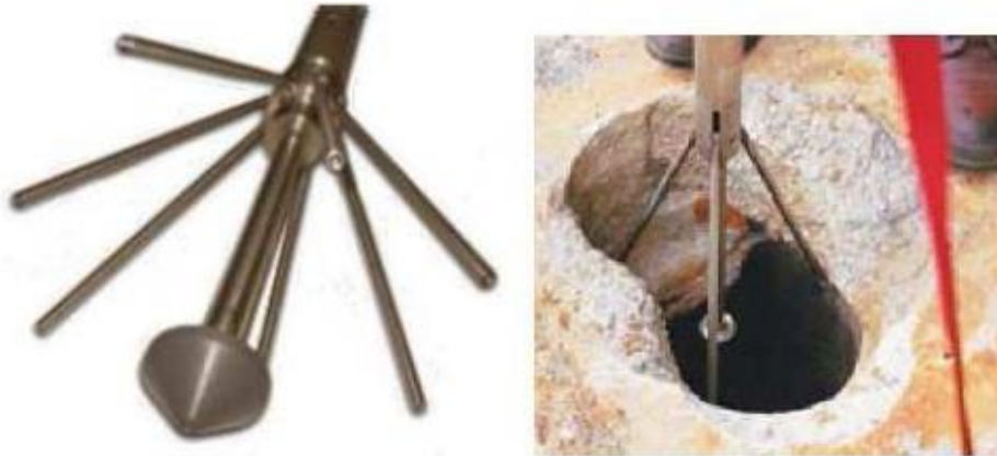
Σχήμα 3.31. : Οι οβίδες που χρησιμοποιούνται για την μέτρηση του Caliper.
