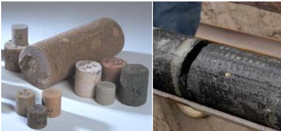
Σχήμα 2.4. :Εικόνες από πυρήνες δειγματοληψίας (Αριστερά : Core Samples, Δεξιά : NMR Core Analysis). 22
