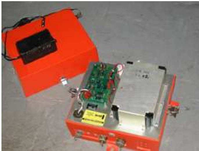
Σχ.6 : Ψηφιακός σύγχρονος επιταχυνσιογράφος, http://www.gein.noa.gr/HTML/WEB-EDU/instruments.htm
