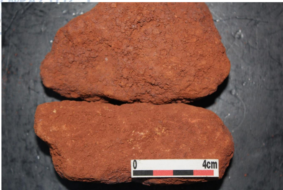
Εικόνα 4.1: Φωτογραφία από δείγματα τροπικών βωξιτών. Οι τροπικοί βωξίτες όπως φαίνεται είναι κόκκινοι λόγω των πολλών οξειδίων και υδροξειδίων του σιδήρου και αρκετά μαλακοί και εύθρυπτοι. Ο ιστός τους δεν είναι ξεκάθαρος. Ωόλιθοι δεν παρατηρούνται.
