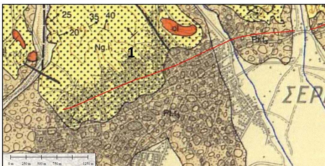
Εικόνα 26 Αποτύπωση του πρώτου ρηξιγενούς πρानούς και του γεωλογικού υποβάθρου που τέμνει, μέσω του προγράμματος Global Mapper 15, προβαλλόμενο στο γεωλογικό χάρτη της περιοχής (Γεωλογικός χάρτης του ΙΓΜΕ, κλίμακας 1:50.000 (φύλλο Σέρρες).
