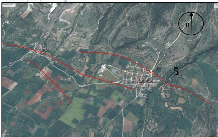
Εικόνα 49 Απεικόνιση του 5 ου ρηξιγενούς πρανούς μέσω του προγράμματος Google Earth Pro προβαλλόμενο στο γεωλογικό χάρτη της περιοχής (Γεωλογικός χάρτης του ΙΓΜΕ, κλίμακας 1:50.000 (φύλλο Σέρρες).
