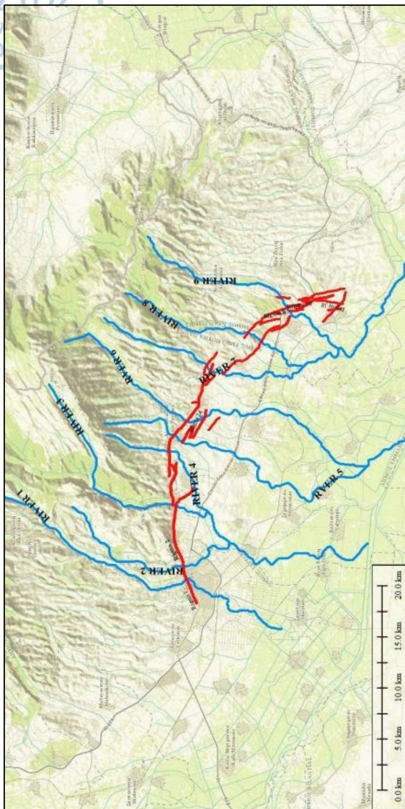
Εικόνα 95 Προβολή των 9 κύριων ρεμάτων και του συνόλου των ρηξιγενών πρανών που τα τέμνουν, μεταξύ της πόλης των Σερρών και της κομόπολης Νέας Ζίχνης, σε μορφολογικό χάρτη μέσω του προγράμματος Global Mapper v 15.
