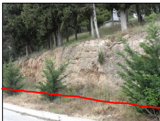
Εικόνα 82 Το 7° ρηξιγενές πρανές έχει παράταξη ΒΔ – ΝΑ και διεύθυνση κλίσης ΝΔ.
