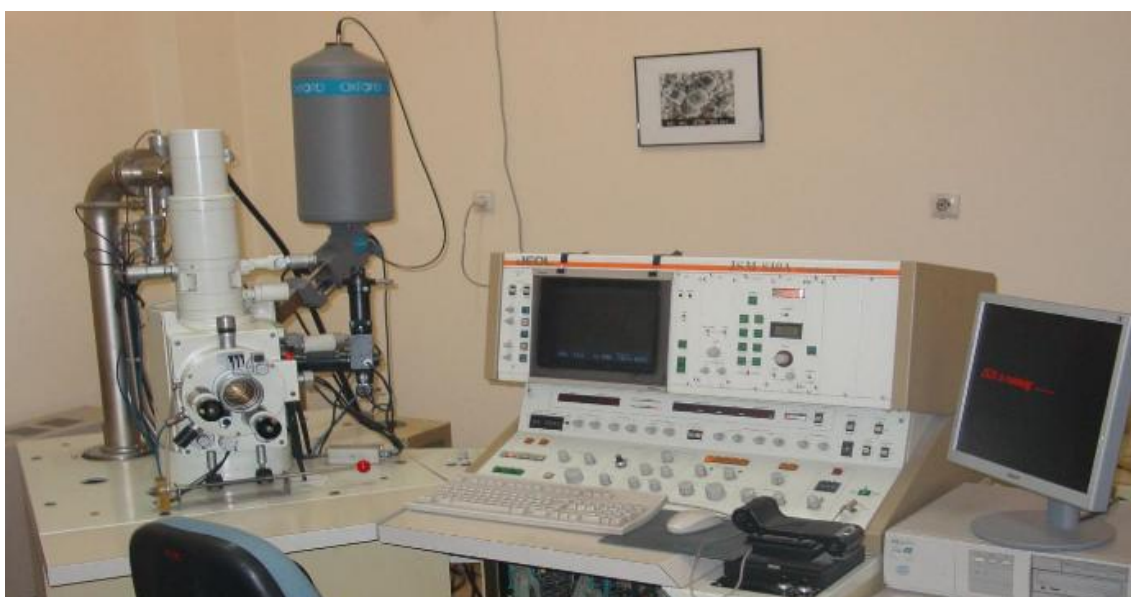
Εικόνα 9. Σαρωτικό ηλεκτρονικό μικροσκόπιο του εργαστηρίου ηλεκτρονικής μικροσκοπίας του Α.Π.Θ.
