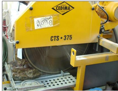
ΕΙΚΟΝΑ 8.72 : Διαμόρφωση δείγματος με τη βοήθεια αδαμαντοτροχού
