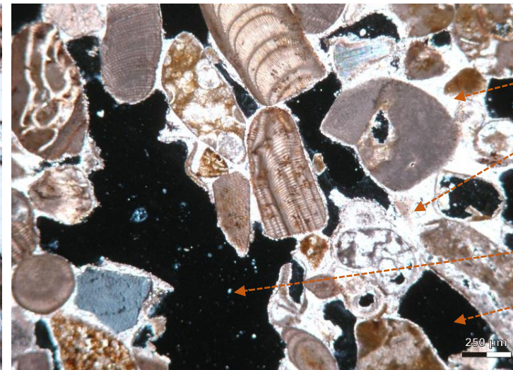
ΕΙΚΟΝΑ 7.60 : Μικροσκοπική παρατήρηση εξεταζόμενου δομικού λίθου, N ⊥ , με μέγιστη διάσταση 250μm
