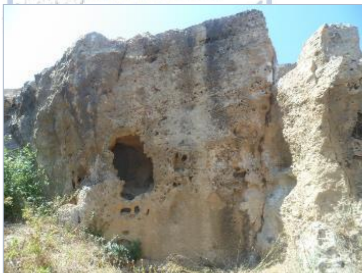
ΕΙΚΟΝΑ3.27: Κυψελοειδής φθορά λόγω ανέμων οι οποίοι μεταφέρουν στα σταγονίδια με υψηλή περιεκτικότητα σε άλατα Λατομείο 4
