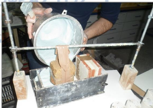
ΕΙΚΟΝΑ 8.74 : Εγκιβωτισμός του πάνω μέρους δοκιμίου.
