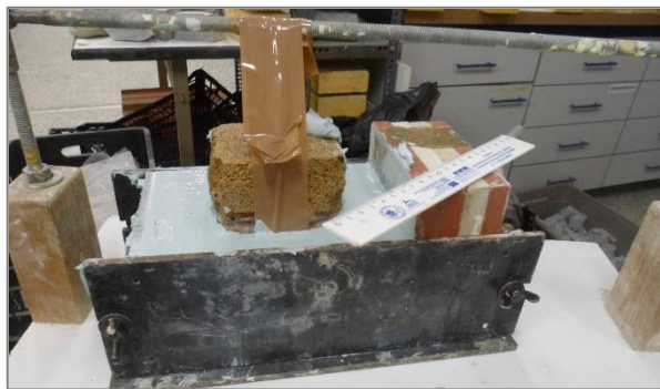
ΕΙΚΟΝΑ 8.74 : Εγκιβωτισμός του πάνω μέρους δοκιμίου.
