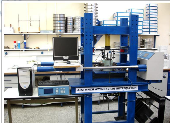
ΕΙΚΟΝΑ 8.77 : Διάταξη συσκευής άμεσης διάτμησης ασυνεχειών βράχου.
