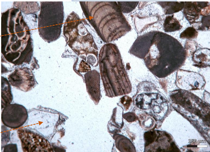
ΕΙΚΟΝΑ 7.59 : Μικροσκοπική παρατήρηση εξεταζόμενου δομικού λίθου, N//, με μέγιστη διάσταση 250μm
