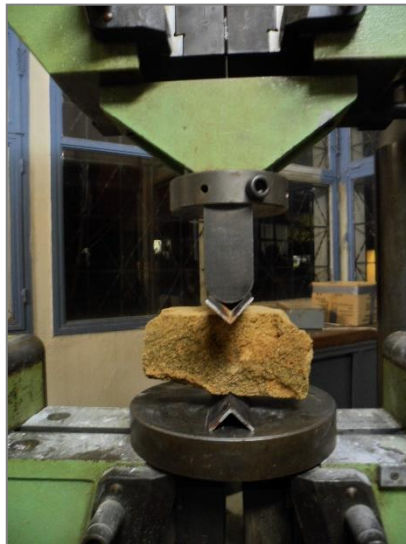
ΕΙΚΟΝΑ 8.73 : Εφελκυστική διάρρηξη με τη χρήση δυο γωνιακών ελασμάτων μέσω των οποίων εφαρμόστηκε το απαιτούμενο γραμμικό φορτίο σε προ-διαμορφωμένη εγκοπή κατά πλάτος του δοκιμίου
