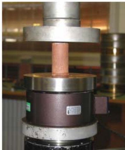
Σχήμα 16: Εδαφικό δοκίμιο σε ανεμπόδιστη θλίψη.
