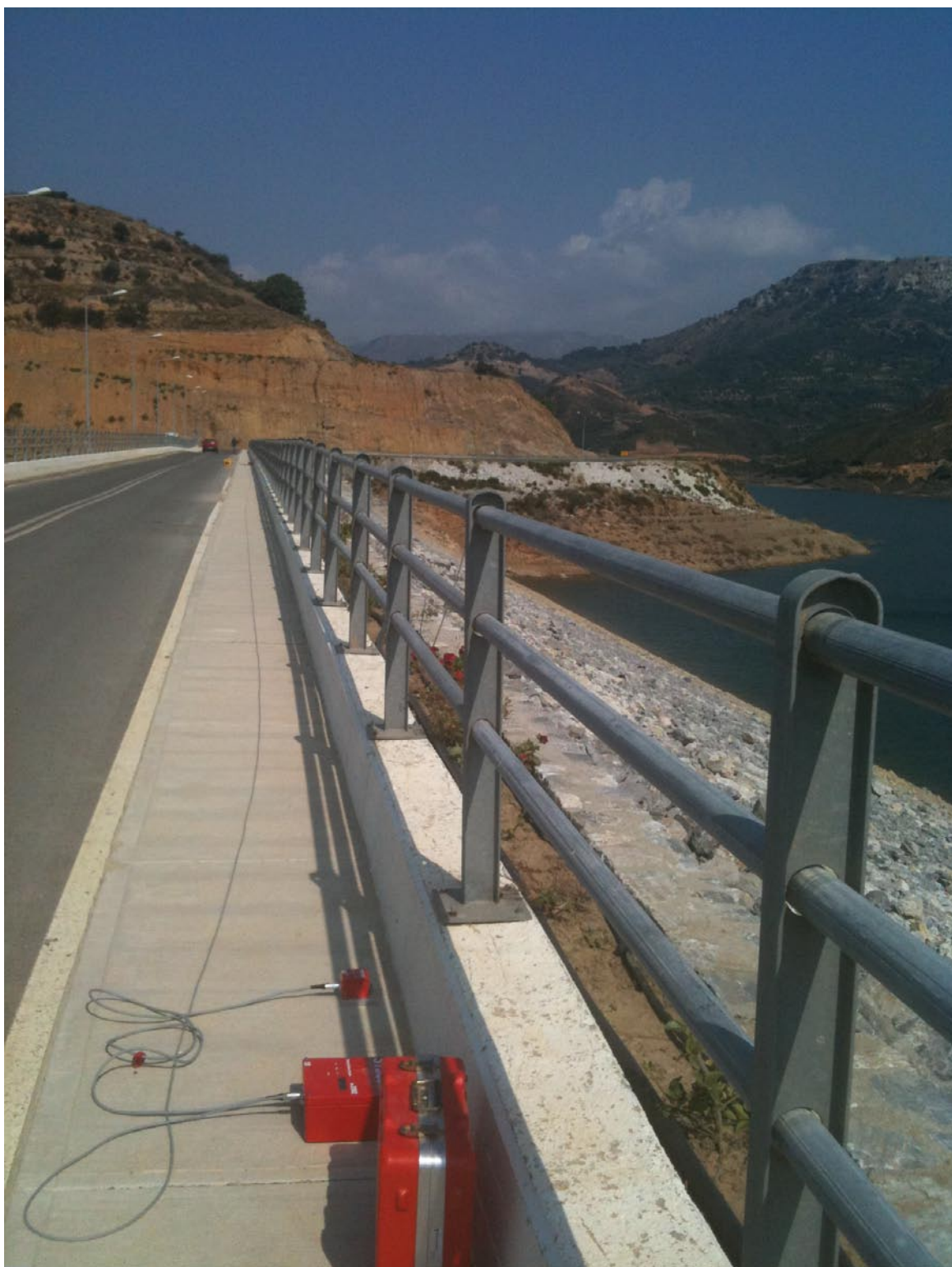
Κατά τη διάρκεια μιας από τις μετρήσεις με το γεώφωνο σε συγκεκριμένη οριζόντια απόσταση (20m περίπου) από τον καταγραφέα, πάνω στο φράγμα.
