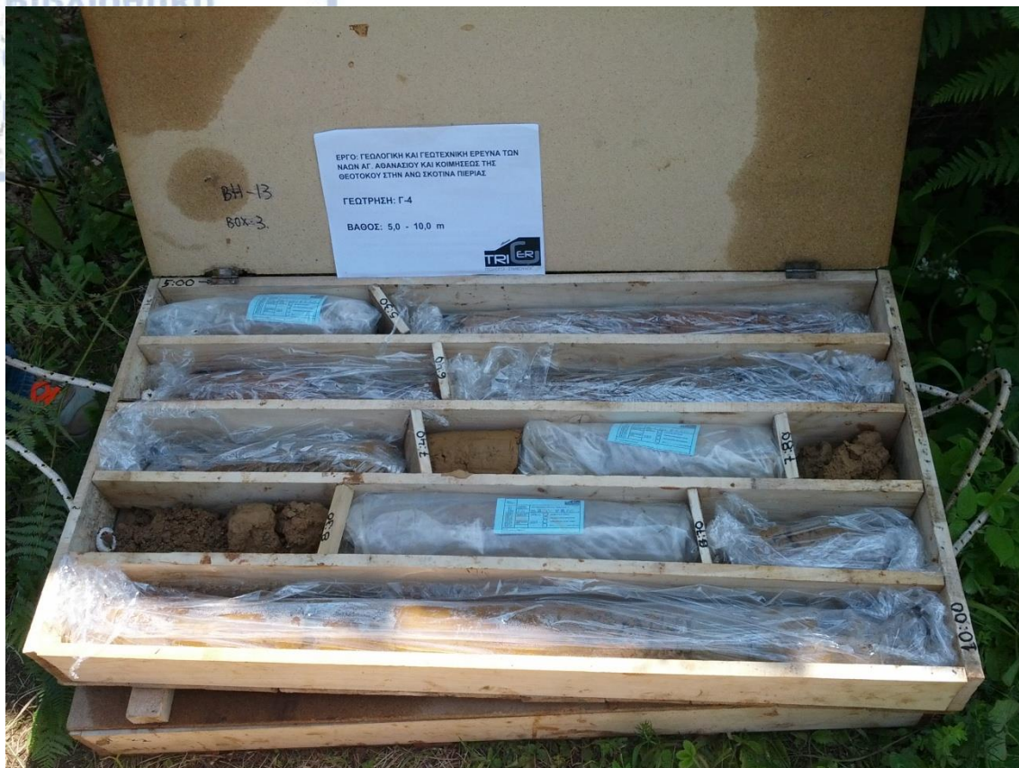
Εικόνα 44: Δειγματοληπτική γεώτρηση Γ4 για βάθος από 5-10m. Από το βάθος των 5 έως και το βάθος των 10μ φαίνεται ο σχηματισμός των αμφιβολιτικών σχιστολίθων, πλήρως αποσαθρωμένοι.
