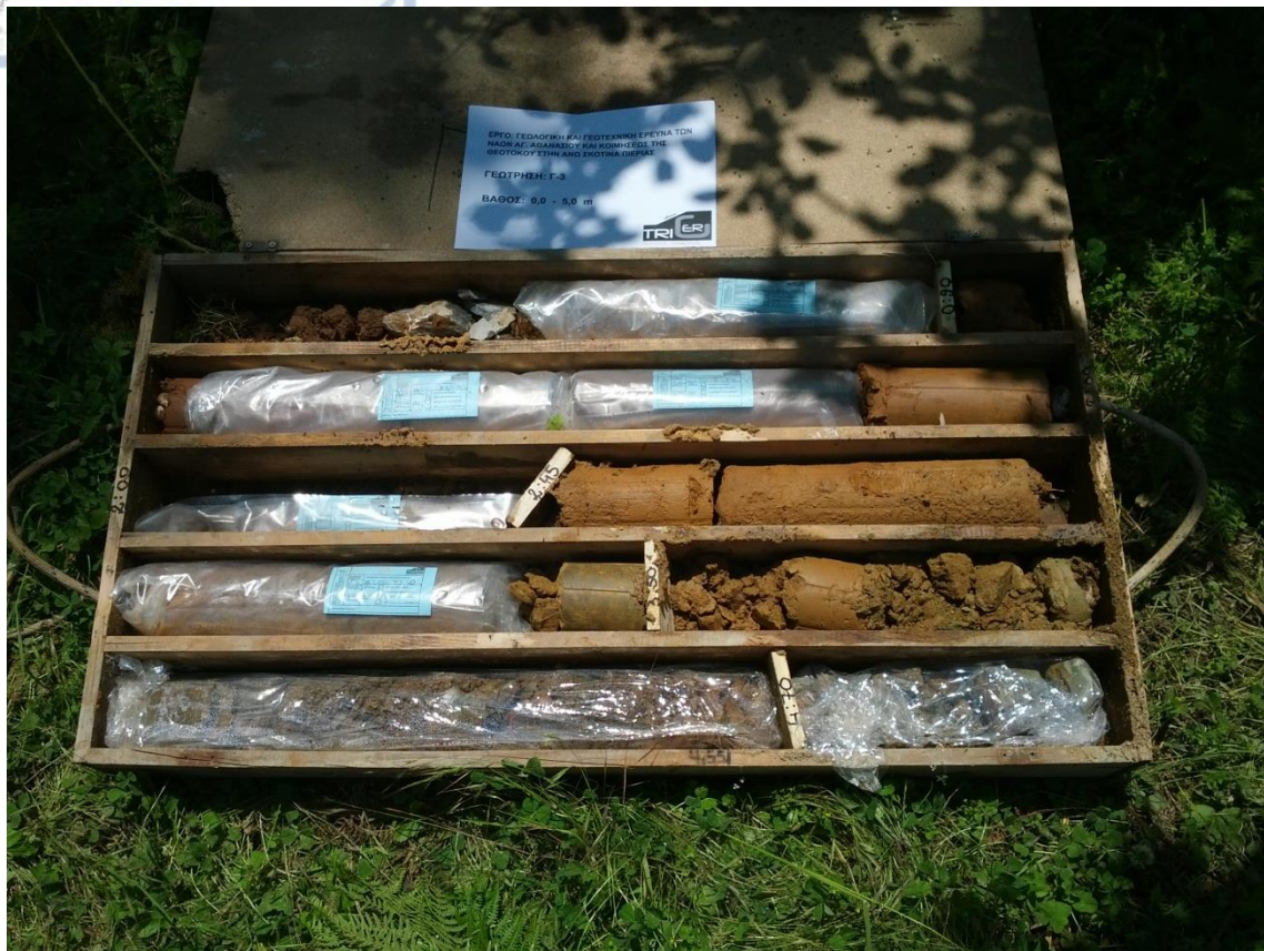
Εικόνα 40: Δειγματοληπτική γεώτρηση Γ3 για βάθος από 0-5m. Από το βάθος των 0m μέχρι και το βάθος φαίνονται οι τεχνητές επιχώσεις.
