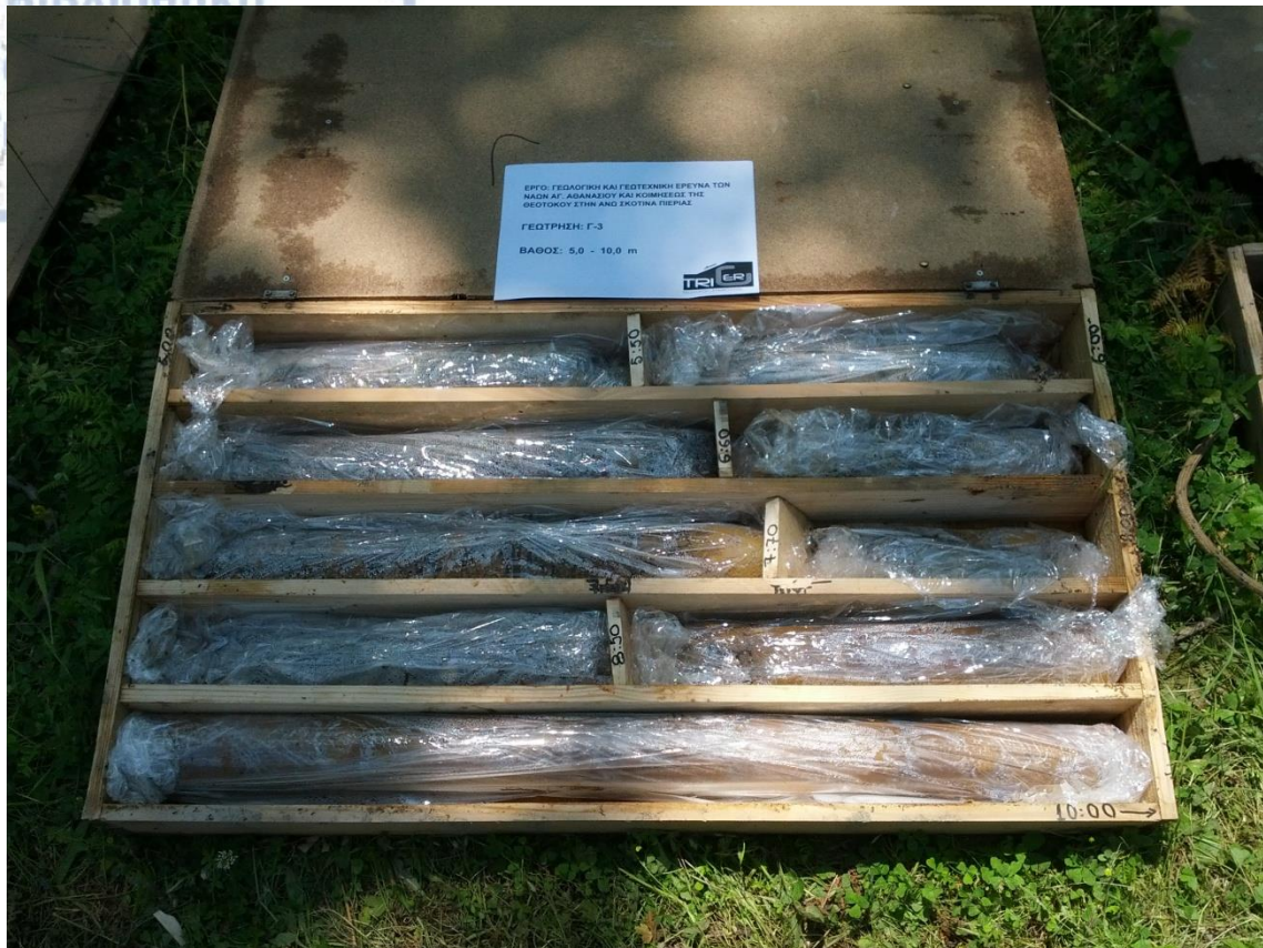
Εικόνα 41: Δειγματοληπτική γεώτρηση Γ3 για βάθος από 5-10m. Από το βάθος των 5 έως και το βάθος των 10μ φαίνεται ο σχηματισμός των αμφιβολιτικών σχιστολίθων, πλήρως αποσαθρωμένοι.
