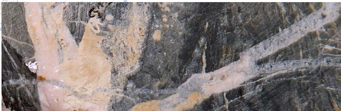
Σχ. 5.14. Επιθερμικές φλέβες χαλαζία και ροδοχρωσίτη από την μεταλλοφορία στην περιοχή Πιάβιτσα. Γεώτρηση PVD88, 125 m.
