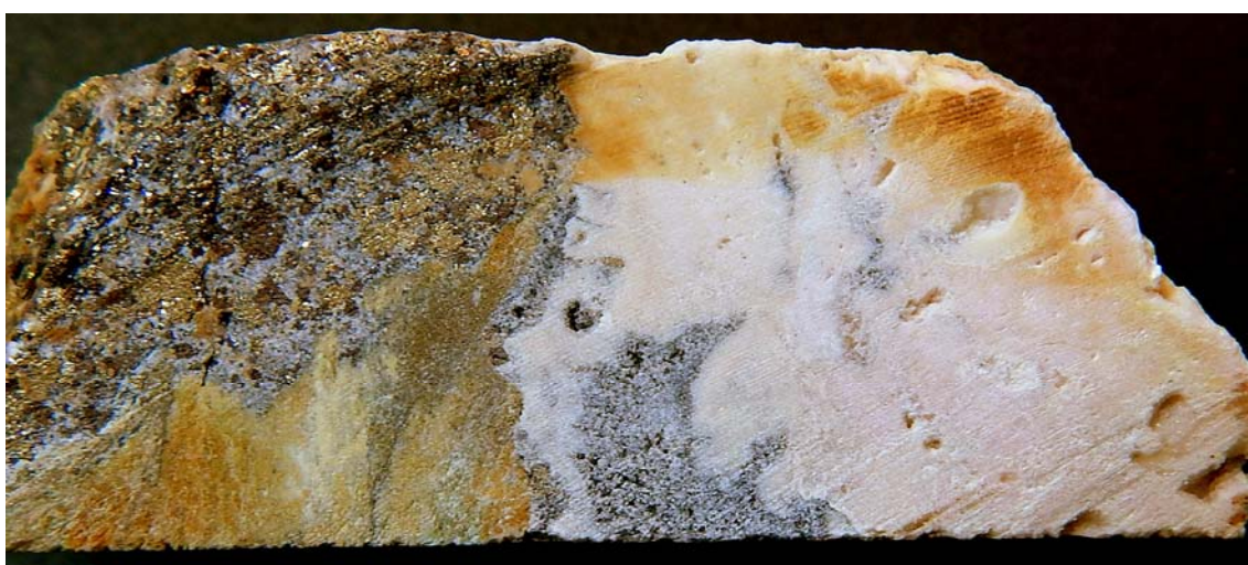
Σχ. 5.15. Επιθερμική μεταλλοφορία σιδηροπυρίτη, και σφαλερίτη με χαλαζία και ροδοχρωσίτη από την μεταλλοφορία στην περιοχή Πιάβιτσα. Γεώτρηση PHG78, 98 m.
