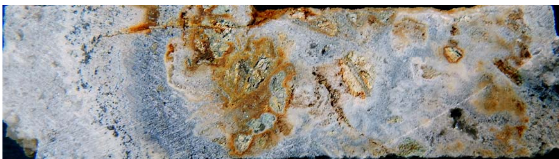
Σχ. 5.16. Ιστός επιθερμικής οξειδωμένης μεταλλοφορίας με χαλαζία και ροδοχρωσίτη από την μεταλλοφορία στην περιοχή Πιάβιτσα. Γεώτρηση PHG78, 102 m.
