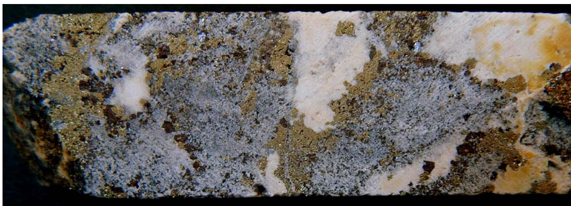
Σχ. 5.9. Ημισυμπαγής μεταλλοφορία σιδηροπυρίτη, σφαλερίτη, γαληνίτη στην περιοχή Πιάβιτσα. Τα σύνδρομα ορυκτά είναι χαλαζίας και σβεστίτης. Γεώτρηση PHG78, 100 m.
