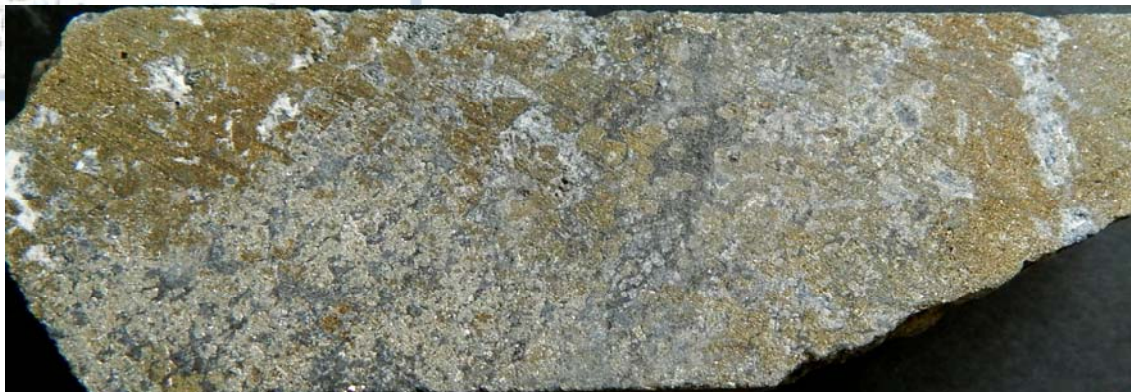
Σχ. 5.8. Συμπαγής μεταλλοφορία σιδηροπυρίτη, σφαλερίτη, γαληνίτη στην περιοχή Πιάβιτσα. Γεώτρηση PHG70, 217 m.
