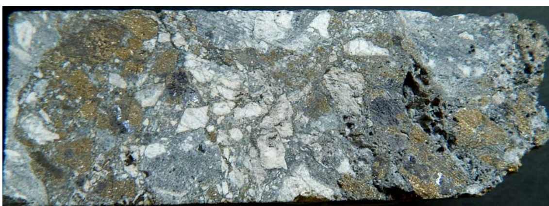
Σχ. 5.12. Λατυποπαγές ημισυμπαγούς μεταλλοφορίας με σιδηροπυρίτη, σφαλερίτη, γαληνίτη στην περιοχή Πιάβιτσα. Οι λατύπες αποτελούνται από μάρμαρο. Γεώτρηση PHG70, 221 m.
