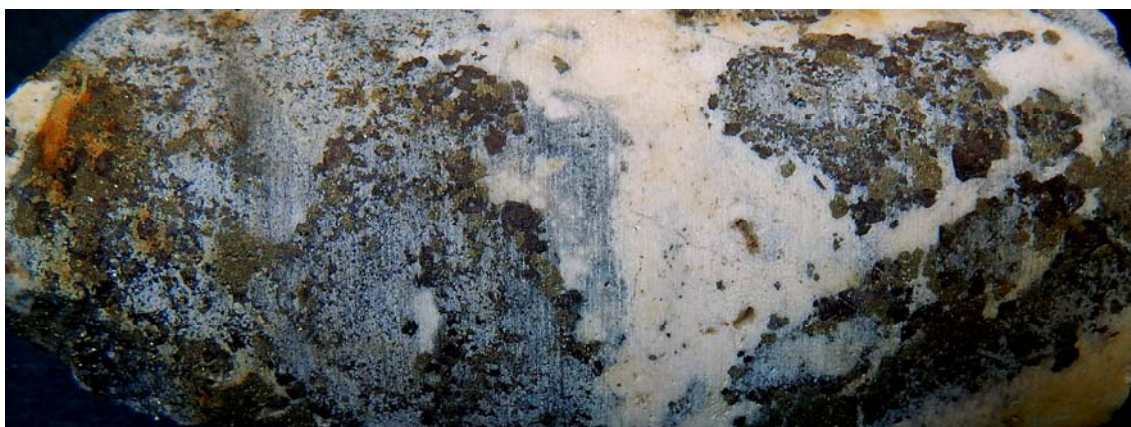
Σχ. 5.10. Ημισυμπαγής μεταλλοφορία σιδηροπυρίτη, σφαλερίτη, γαληνίτη στην περιοχή Πιάβιτσα. Τα σύνδρομα ορυκτά είναι χαλαζίας και σβεστίτης. Γεώτρηση PHG78, 100 m.
