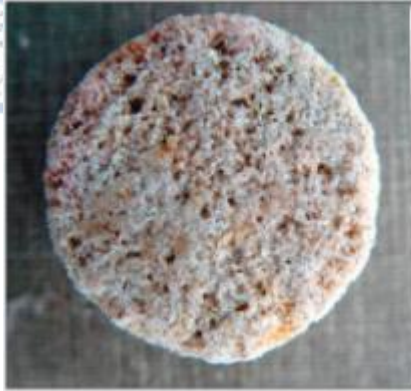
Σχήμα 3.3. Πυρήνας κλαστικού πετρώματος (αριστερά), πυρήνας ανθρακικού πετρώματος (δεξιά) (23) .
