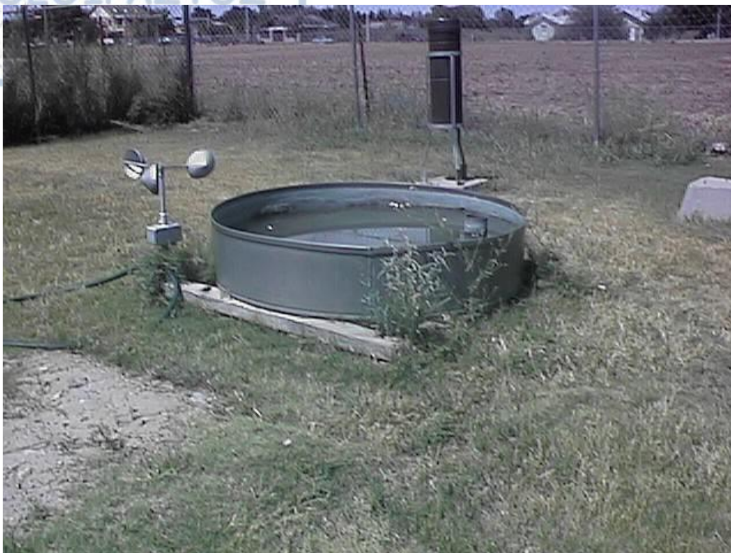
Σχήμα 1.2. Εξατμισόμετρο δι' αγκίστρου σε μετεωρολογικό σταθμό
