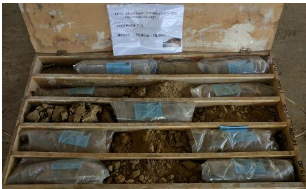
Εικόνα 6: Δειγματοληπτική Γεώτρηση Γ-1 για Βάθος 10,00-15,00m.
