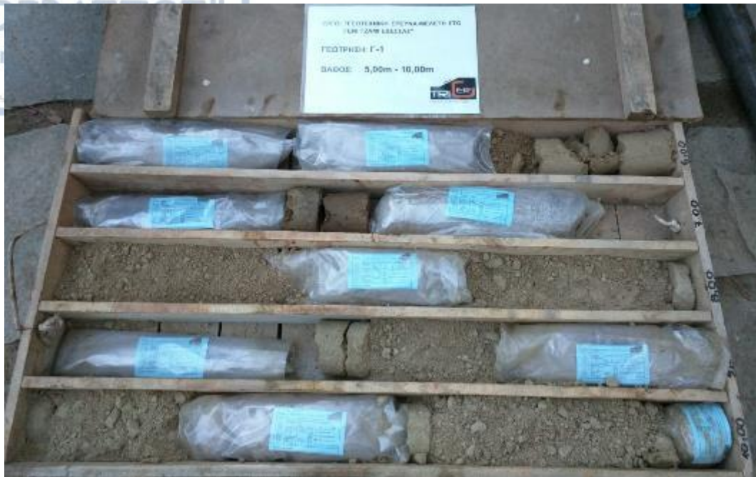
Εικόνα 5: Δειγματοληπτική Γεώτρηση Γ-1 για Βάθος 5,00-10,00m.
