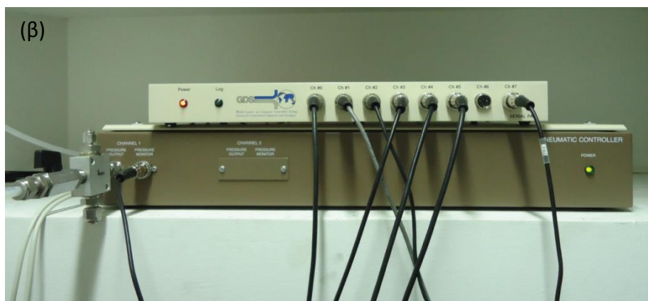
Εικόνα 20: (α) Ηλεκτρονικός ελεγκτής υψηλής ακρίβειας νερού "Standard Pressure/Volume Controller (STDDPC) v2", (β) Πνευματικός ελεγκτής υψηλής ακρίβειας αέρα "Pneumatic Pressure Controller (GDSPPC)". (Βλάχος, 2015)
