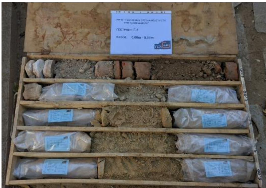
Εικόνα 4: Δειγματοληπτική Γεώτρηση Γ-1 για Βάθος 0,00-5,00m.
