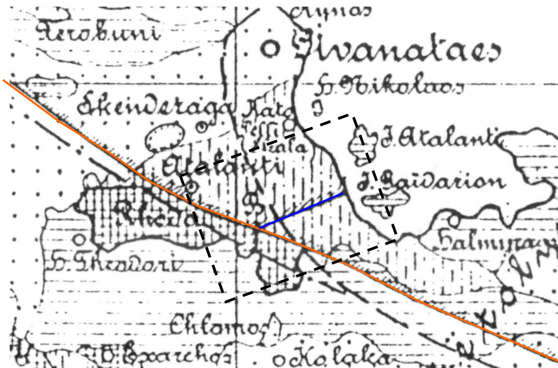
Εικόνα 7. Μεγέθυνση του πλαισίου στο χάρτη 2 όπου με κόκκινο χρώμα τονίζεται η κύρια διάρρηξη και με μπλε, μέσα στο κεκλιμένο μαύρο πλαίσιο, η μικρότερη.
