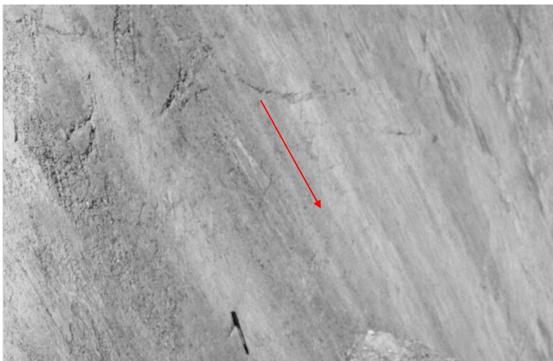
Φωτ.8 Κοντινή φωτογραφία της μεγάλης κατοπτρικής επιφάνειας (Α) της φωτογραφίας 9 και η σύγκρισή του μεγέθους των γραμμώσεών του με το εικονιζόμενο στυλό. (μήκος 15cm.) (Το κόκκινο βέλος δείχνει τη φορά της κίνησης)
