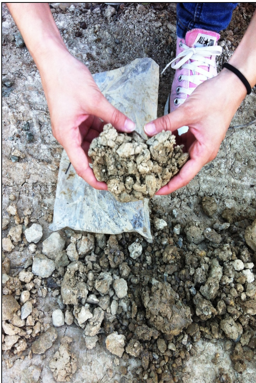
Φωτογραφία 1: Εικόνα από τα κροκαλοπαγή της περιοχής όπως εξορύχτηκαν από μία υδρογεώτρηση.
