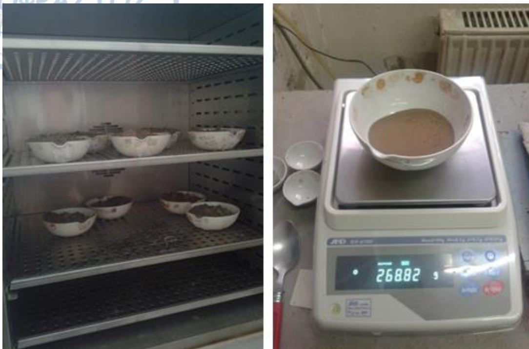
Σχήμα 23. Η πρώτη εικόνα απεικονίζει τα τοποθετημένα για ξήρανση δείγματα, ύστερα από την ζύγιση τους. Ενώ, στην δεξιά εικόνα απεικονίζεται ο ζυγός ακριβείας, και το ξηρό υλικό. Οι φωτογραφίες λήφθηκαν στο Εργαστήριο Τεχνικής Γεωλογίας και Υδρογεωλογίας του Τμήματος Γεωλογίας, Α.Π.Θ., κατά την ανάλυση των δειγμάτων.
