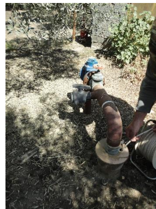
Σχήμα 14. Εικόνες από την απογραφή των γεωτρήσεων και την μέτρηση στάθμης με το σταθμήμετρο του Εργαστηρίου Τεχνικής Γεωλογίας και Υδρογεωλογίας, του Τμήματος Γεωλογίας, Α.Π.Θ...
