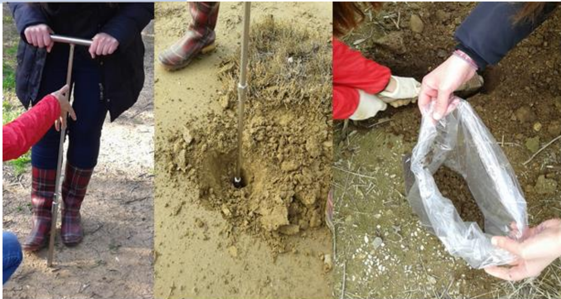
Σχήμα 22. Στην πρώτη φωτογραφία απεικονίζεται ο δειγματολήπτης, στην δεύτερη, η δειγματοληψία και στην τρίτη φωτογραφία η συλλογή του υλικού.
