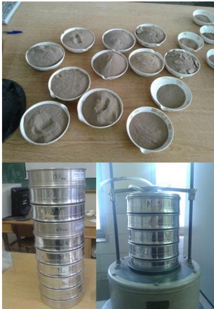
Σχήμα 24. Στην παραπάνω εικόνα, απεικονίζονται τα δείγματα υστέρα από την επεξεργασία τους με γουδί. Στην κάτω φωτογραφία, απεικονίζεται η σειρά των κόσκινων που χρησιμοποιήθηκαν για την ανάλυση αυτή, καθώς και η αυτόματη συσκευή κοσκινίσματος. Οι παραπάνω φωτογραφίες λήφθηκαν στο Εργαστήριο Τεχνικής Γεωλογίας και Υδρογεωλογίας, του Τμήματος Γεωλογίας, Α.Π.Θ..
