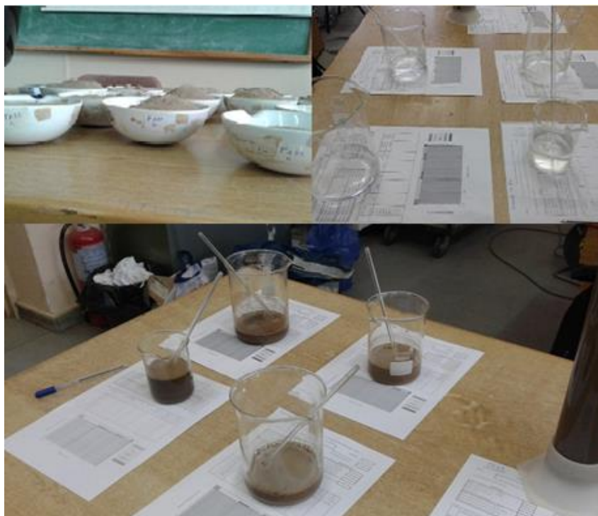
Σχήμα 25. Στην εικόνα παρουσιάζονται τα έτοιμα για ανάλυση δείγματα, τα ποτήρια ζέσεως μαζί με το πολυφωσφορικό νάτριο και τέλος το διάλυμα πολυφωσφορικού νατρίου και εδαφικού υλικού, έτοιμο για την 24ωρη διαβροχή του. Οι παραπάνω φωτογραφίες λήφθηκαν στο Εργαστήριο Τεχνικής Γεωλογίας και Υδρογεωλογίας, του Τμήματος Γεωλογίας, Α.Π.Θ..
