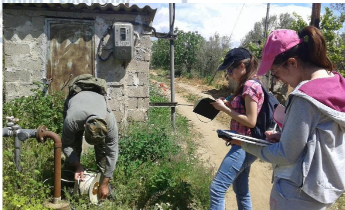
Σχήμα 14. Εικόνες από την απογραφή των γεωτρήσεων και την μέτρηση στάθμης με το σταθμήμετρο του Εργαστηρίου Τεχνικής Γεωλογίας και Υδρογεωλογίας, του Τμήματος Γεωλογίας, Α.Π.Θ...
