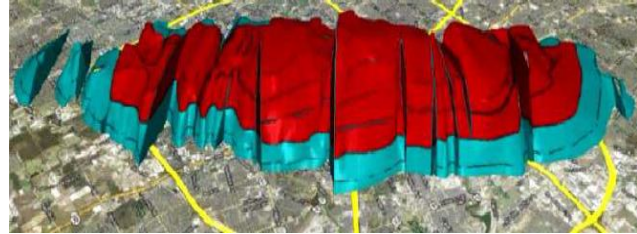
Εικόνα 45: Αντικλινική δομή του κοιτάσματος Ταμάρ (αριστερά) και αποτύπωση του έντονου τεμαχισμού του από την δράση κανονικών ρηγμάτων από 3D σεισμικά (δεξιά) (Ben-Gai and Druckman)
