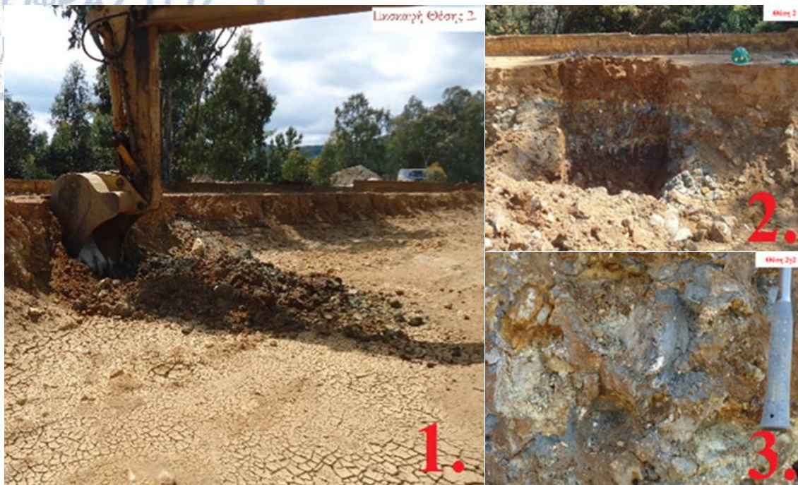
Εικόνα 2.7. Θέσεις δειγματοληψίας και εκσκαφών της τομής με κωδικό «Θέση 2». 1.) Η εκσκαφή της εδαφοτομής, 2.) Εικόνα υπαίθρου εδαφοτομής αμέσως μετά την εκσκαφή όπου διακρίνεται ο ορίζοντας αποθέσεων εμπλουτίσματος σιδηροπυρίτη, 3.) Οξειδωμένος ορίζοντας συμπυκνώματος σιδηροπυρίτη.
