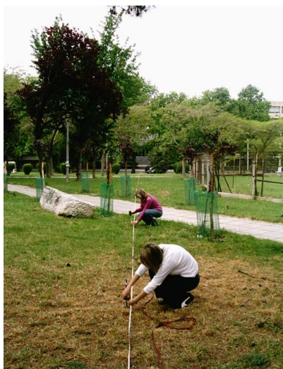
Φωτογραφία 2. Τοποθέτηση χάλκινων ηλεκτροδίων.
