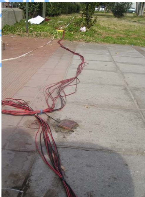
Φωτογραφία 3. Ηλεκτρόδιο επαφής όπως χρησιμοποιείται στις μετρήσεις υπαίθρου.
