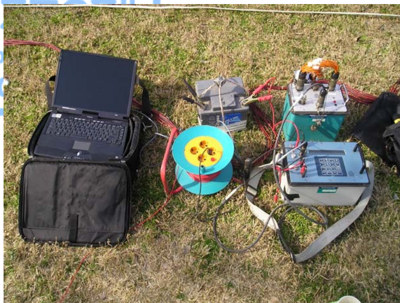
Φωτογραφία 1. Εξοπλισμός που χρησιμοποιήθηκε στο ύπαιθρο με όργανο λήψης ηλεκτρικών μετρήσεων SYSCAL (V11.4++) της εταιρείας IRIS INSTRUMENTS.
